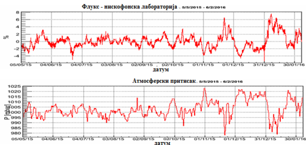
Слика 3.14 Притисак и одброј космичких зрака детектованим за исти временски интервал. Измерено у Нискофонској лабораторији у Земуну.
