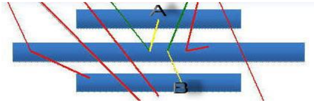
Слика 5.60 Распоред детектора у експерименту мерења поларизације миона космичког зрачења. Посматра се асиметрија догађаја означених као А и В.
