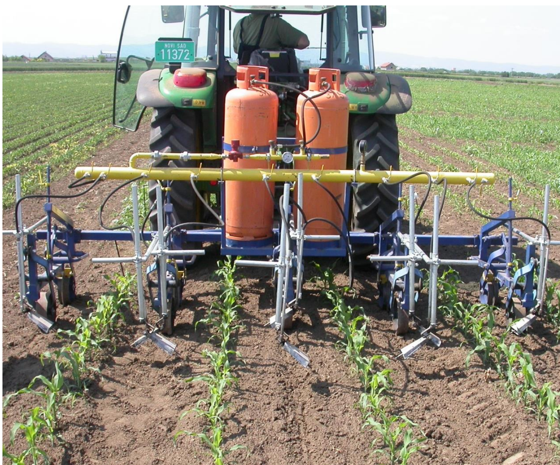
Slika 5. Mašina za suzbijanje korova plamenom (orig., 2012)
