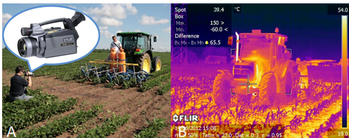
Slika 9. Termografsko merenje temperatura: (A) Termovizijsko snimanje u usevu soje (foto: G. Malidža, 2012), (B) Termovizijska slika (termogram) mašine za suzbijanje korova plamenom (foto: Lj. Čičkarić, 2012)
