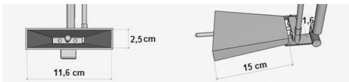
Slika 8. Izgled plamenika za suzbijanje korova plamenom sa prednje i bočne strane sa dimenzijama (orig., 2016)
