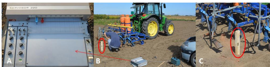
Slika 10. Merenje temperature plamena: (A) analogni loger, (B) postavljanje termoparova, (C) termoparovi zaštićeni drvenim kućištem, (orig., 2013)
