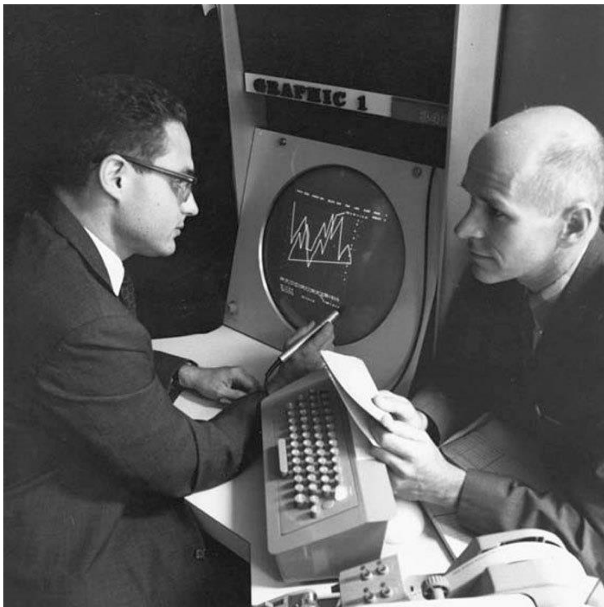
Primer 7: Graphic 1, rani vid CRT (cathode ray tube) monitora na kojem su grafički (slikovno) predstavljene informacije o zvuku uz pomoć IBM 704 mejnfrejma. 149
