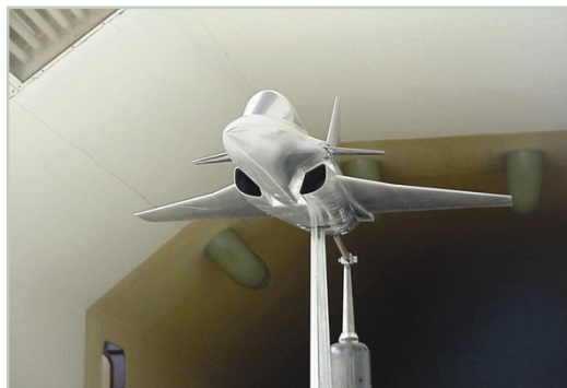
Слика 2-8. Модел авиона у субсоничном аеротунелу VTI T-35 (Београд, Србија)
