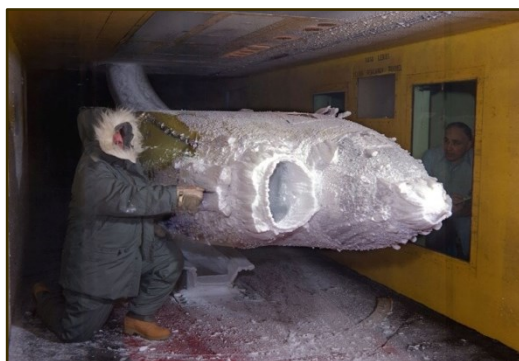
Слика 2-11. Модел авиона у аеротунелу NASA Glenn IRT (Охајо, САД) (Фотографија: NASA)
