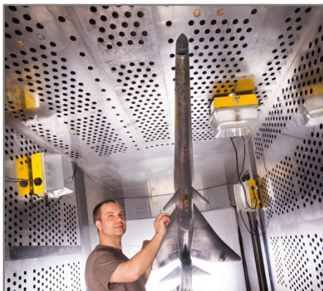
Слика 2-17. Модел суперсоничног путничког авиона X-Plane (Lockheed Martin) у суперсоничном аеротунелу, NASA GRC (Охајо, САД) (Фотографија: NASA)
