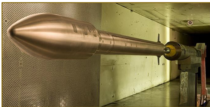
Слика 2-18. Модел (1:33) ракетног носача SpaceX Falcon 9 у аеротунелу (Фотографија: SpaceX)
