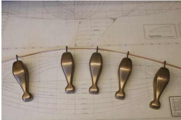
Slika 1.1 Drafting splajn – tehnika crtanja pomoću drvenih letvica
