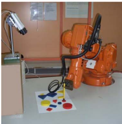
Сл. 4.1 Индустијски робот ABB IRB140 са две мрежне камере за стереовизију AXIS 211 IP. На столу се налази скуп дрвених објеката који представљају просторни контекст који робот дели са корисником приликом интеракције. Слика преузета из [102].
