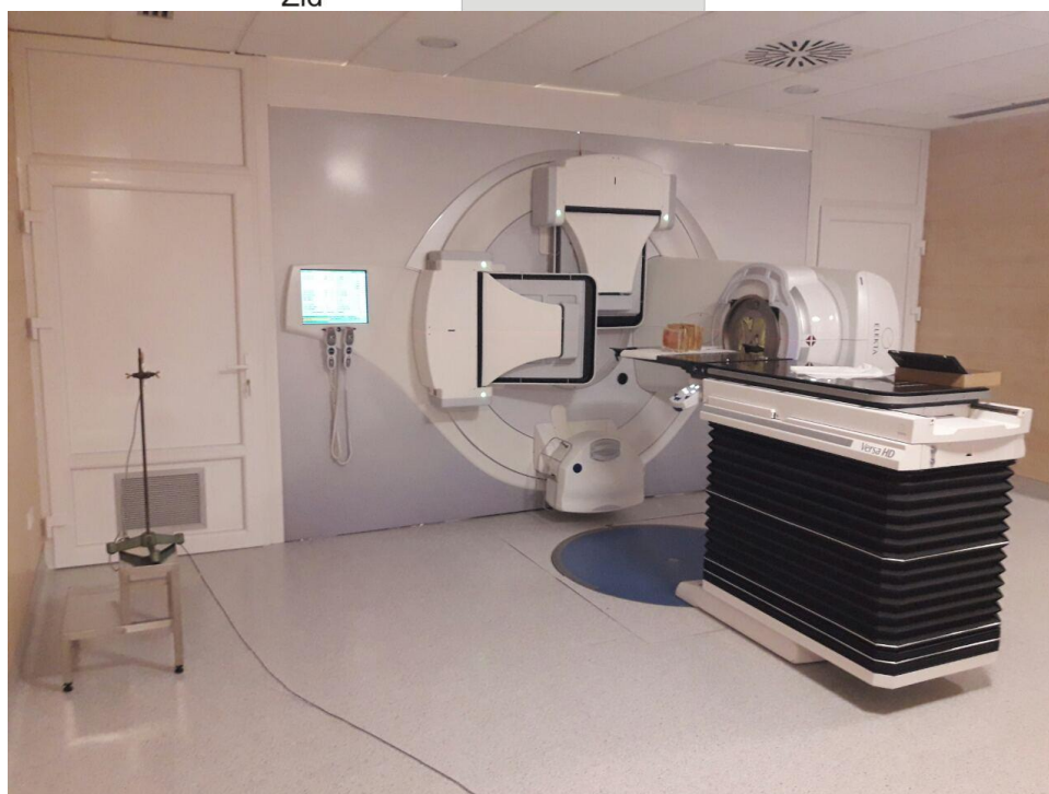
Slika 4.9. Eksperimentalna postavka atenuacionih merenja.
