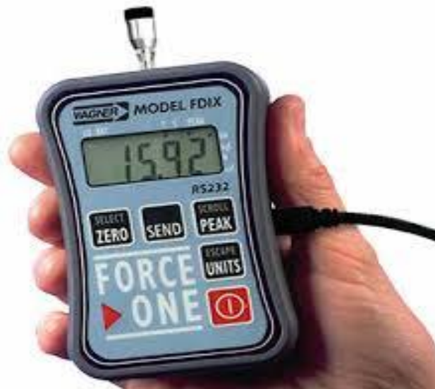
Slika 8. Digitalni algometar korišten u istraživanju
