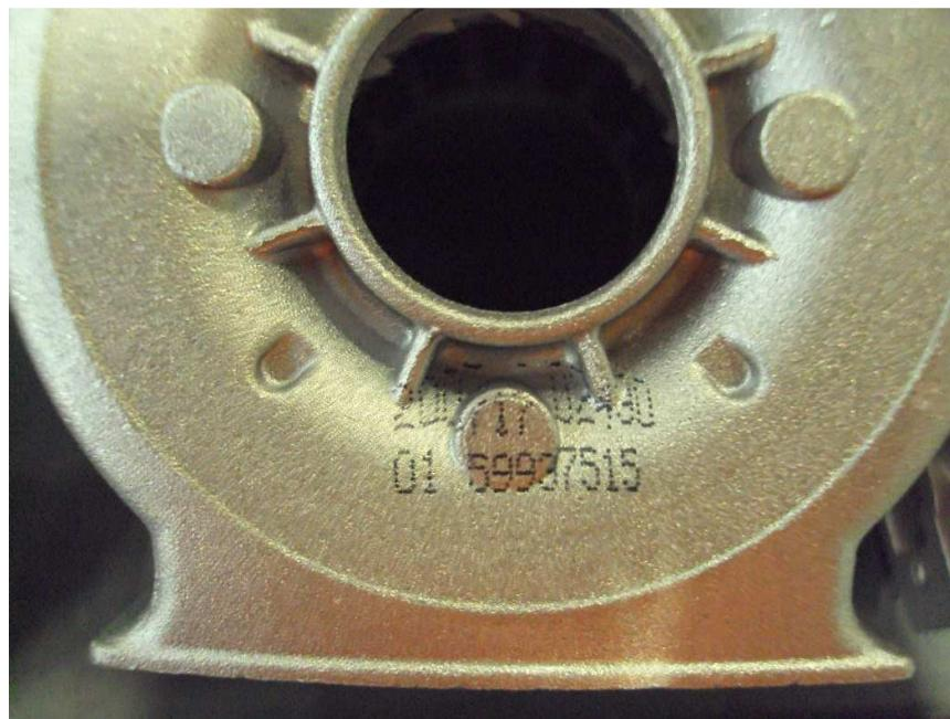
*Slika 5.8.11 Obeleženo kućište cirkulacione pumpe*
