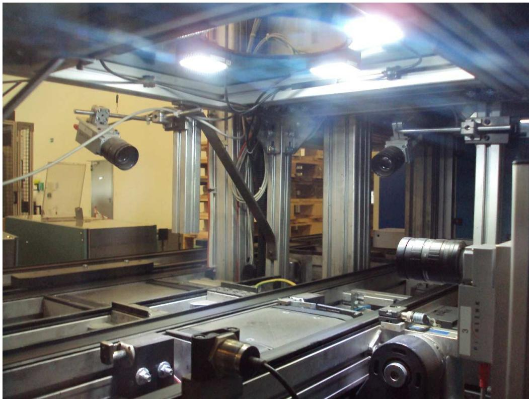
Slika 5.8.31 Stanica za proveru ispravnosti sklopa motora i kućišta cirkulacione pumpe
