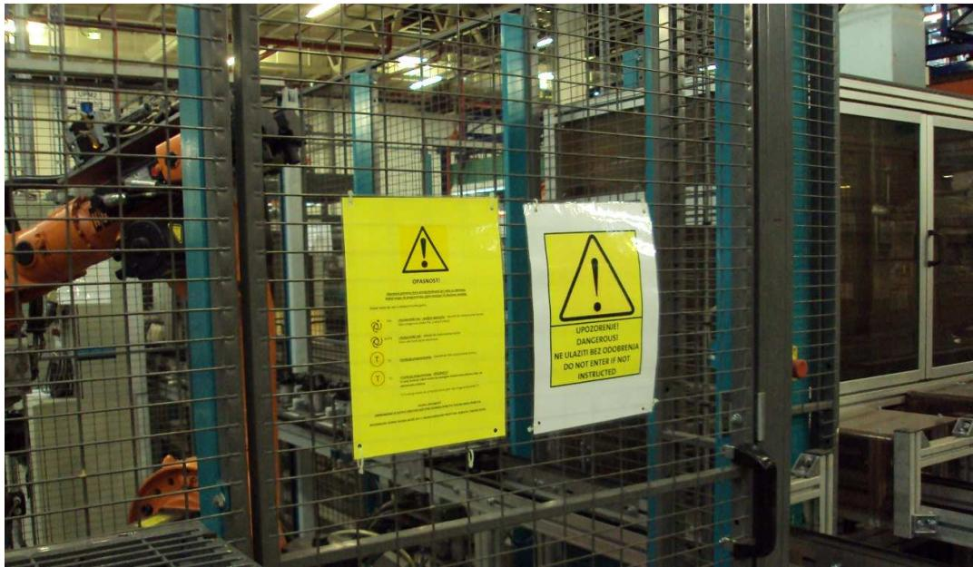
Slika 5.8.2 Elementi vizuelnog menadžmenta na kavezu robotizovanog manipulatora
