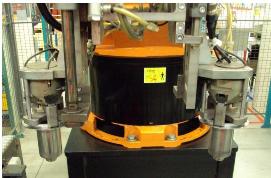
Slika 5.8.15 Manipulator za postavljanje čaure rotora na kućište
