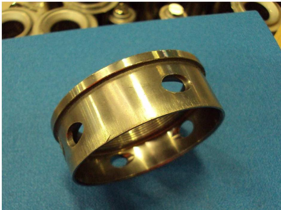
*Slika 5.7.2 Pribor za pozicioniranje statora pri montaži u kućište motora*
