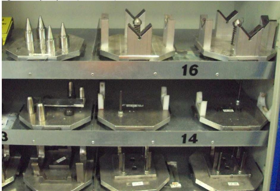
Slika 5.7.5 Različite vrste pribora za fiksiranje kućišta pumpe
