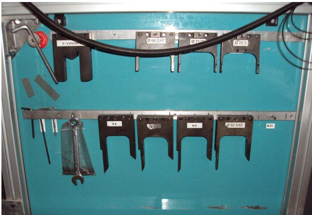
Slika 5.8.20 Mesto odlaganja alata za pozicioniranje radnog kola
