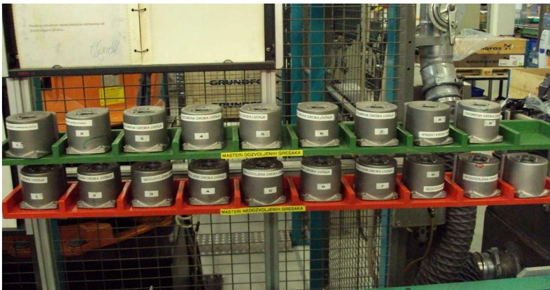
Slika 5.8.4 Uzorci kućišta motora priloženi u okviru uputstva za kontrolu kvaliteta
