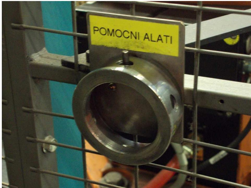
Slika 5.8.8 Obeleženo mesto za odlaganje pomoćnog alata za pozicioniranje statora motora
