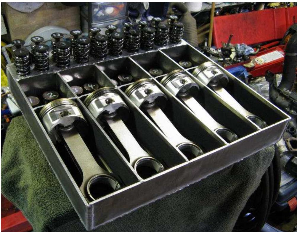
*Slika 3.5.2 Nosač sa određenom količinom delova potrebnih za sklapanje SUS motora*
