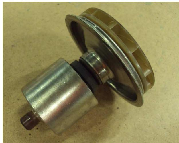
Slika 5.8.23 Sklop rotora
