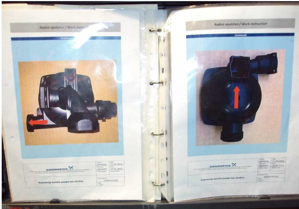
Slika 5.8.29 Fotografije pravilno postavljenog kućišta pumpe u okviru standardnih radnih uputstava
