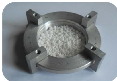
Slika 3.7. Kalup sa sredstvom za sušenje i filmom nanokompozita pri merenju propustljivosti vodene pare.
