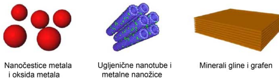
Slika. 2.10. Nanočestice punioca sa dimenzijama manjim od 100 nm. [25]
