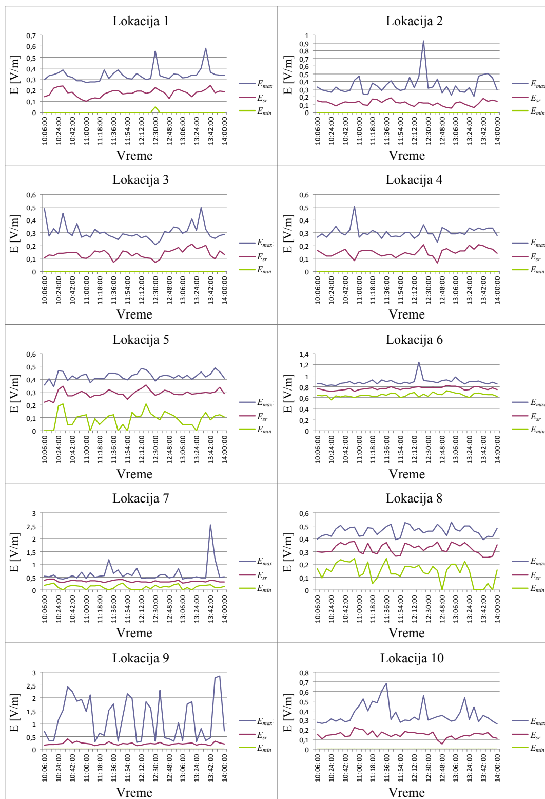
Slika 28. Rezultati monitoringa nivoa polja u kampusu Univerziteta u Novom Sadu [88].
