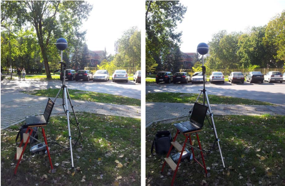
Slika 36. Postavka analizatora spektra FSH3 na lokaciji broj 6.
