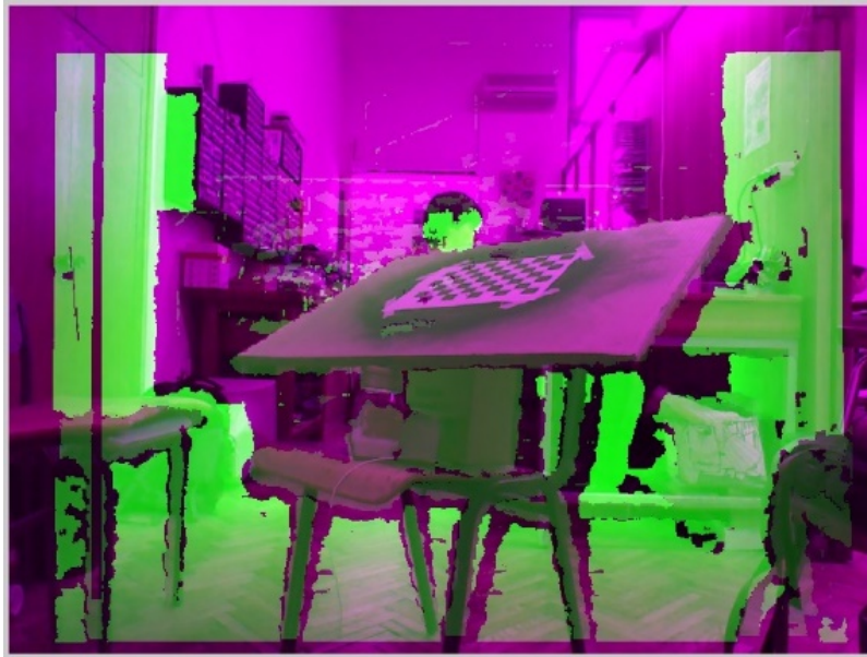
Slika 4.3. Združenom kalibracijom RGB i dubinskog toka sa Kinect senzora i korišćenjem šablona šahovske table na tabli kartona dolazi se do odgovarajućeg preslikavanja između RGB i dubinske slike koje su formirane iz različitih perspektiva dve kamere
