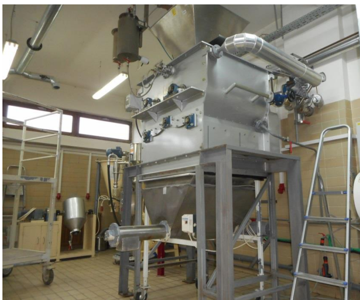
Slika 3.5. Dvoosovinska lopatasta mešalica/kondicioner (model SLHSJ0.2, Muyang, Yangzhou, Kina)
