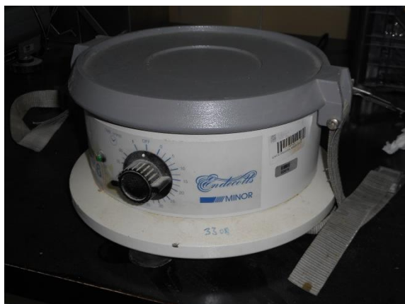
Slika 3.3 Laboratorijsko sito Endecotts minor (Endecotts, London, Velika Britanija)
