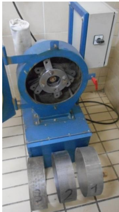
Slika 3.1. Mlin čekićar (ABC Inženjering, Pančevo, Srbija) i korišćena sita
