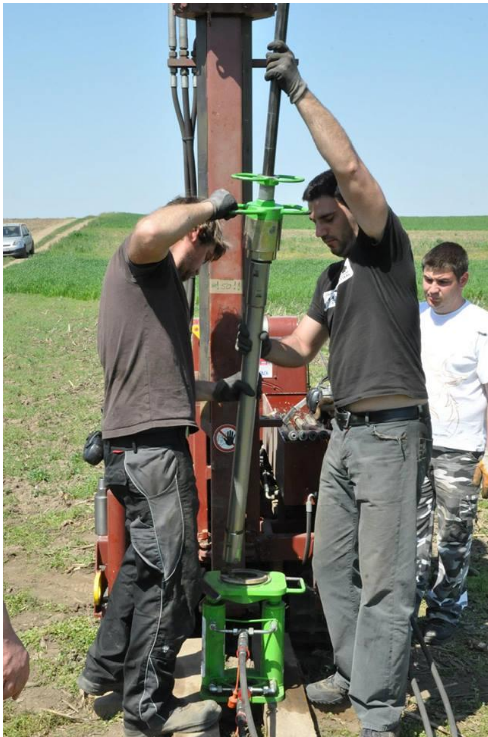
Прилог 63. Узимање узорака методом језгровања (Фото: Hambach, 2013).
