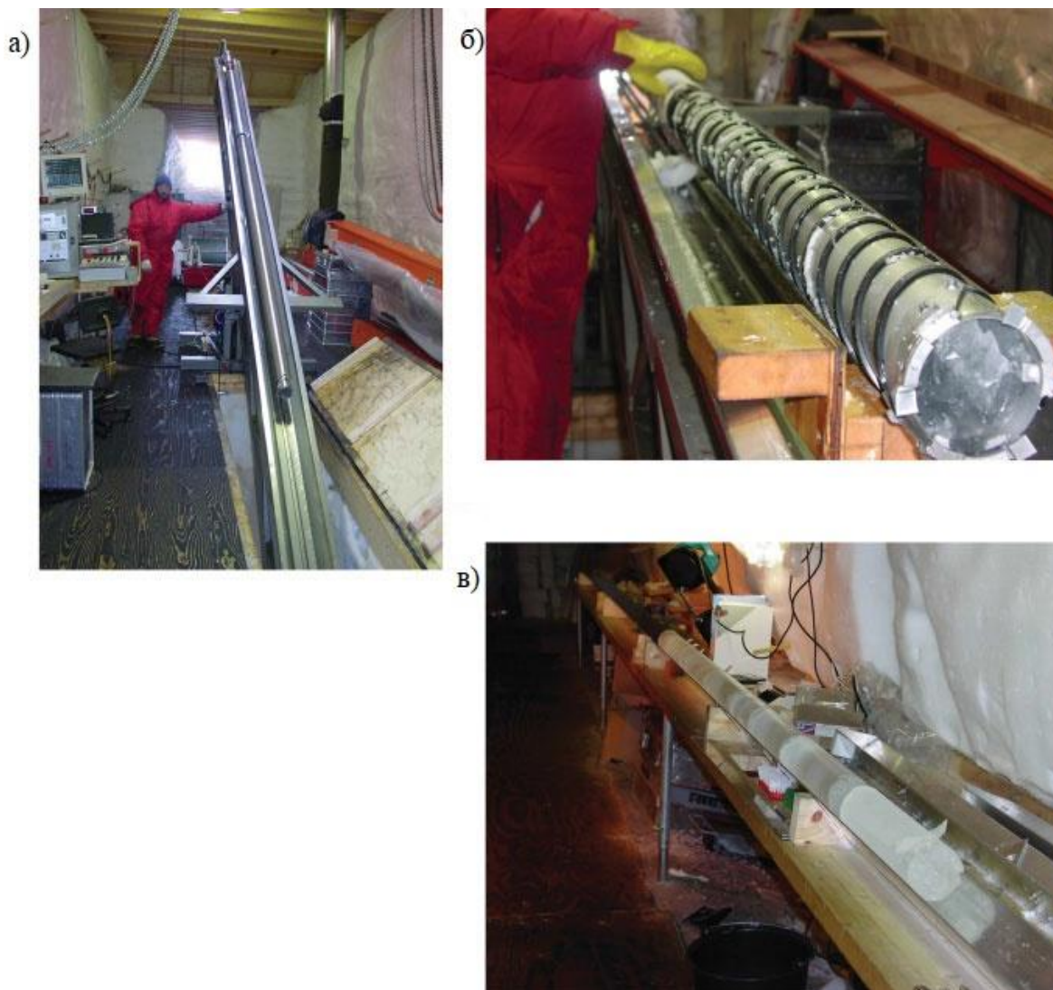
Прилог 15. Ледено језгровање. а) Постављање бушилице. б) Ледено језгро у бургији непосредно пре извлачења. в) Екстраховано ледено језгро (Centre for Ice and Climate: www.iceandclimate.dk ).
