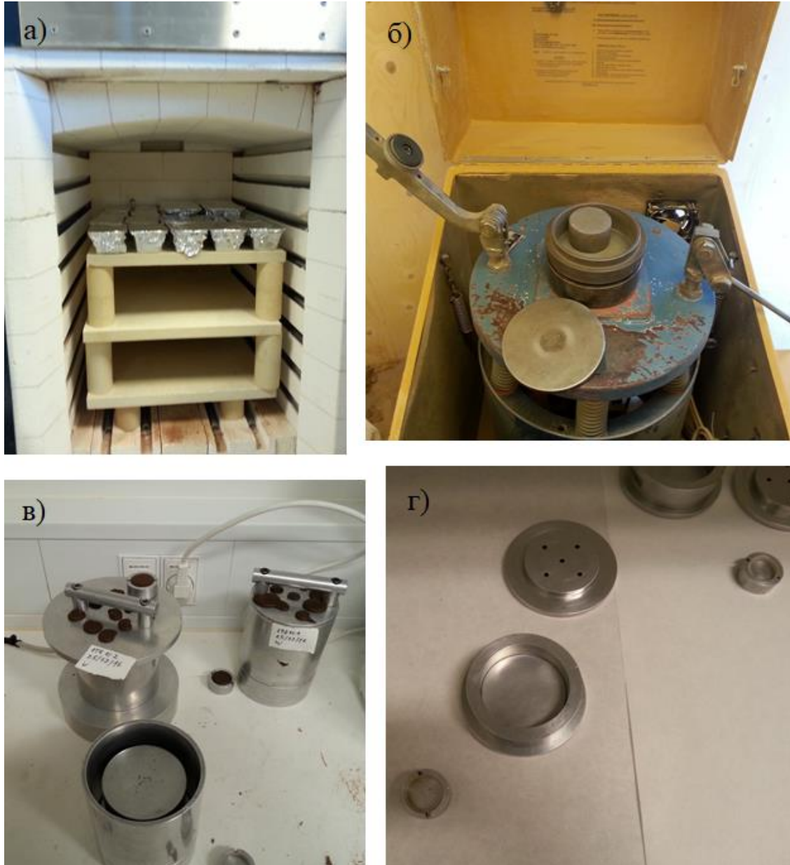
Прилог 66. Процес припреме узорака за гама спектрометрију: а) спаљивање узорка у пећи отпорној на високе температуре; б) млевење седимента у прстенастој дробилици; в) изливени узорци помешани са воском у Маринели геометрији; г) калуп у облику диска за мање узорке (Фото: Перић, 2017).
