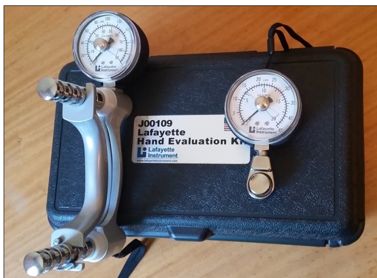
Слика 03.13-1: Динамометри коришћени за евалуацију снаге стиска шаке и “кључ” стиска
