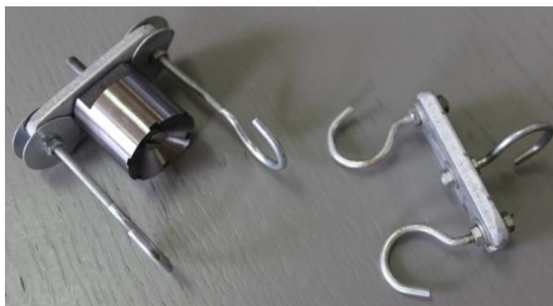
Слика 5.14 Фотографски приказ система полулица за обезбеђивање потребног оптерећења на испитивани контактни елемент
