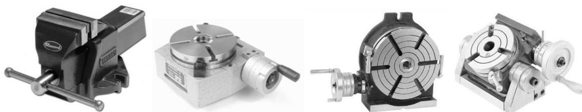
Слика 2.3 Универзални стезни прибори (стега, хоризонтално обртни прибор, вертикално обртни прибор, заокретни обртни прибор)
