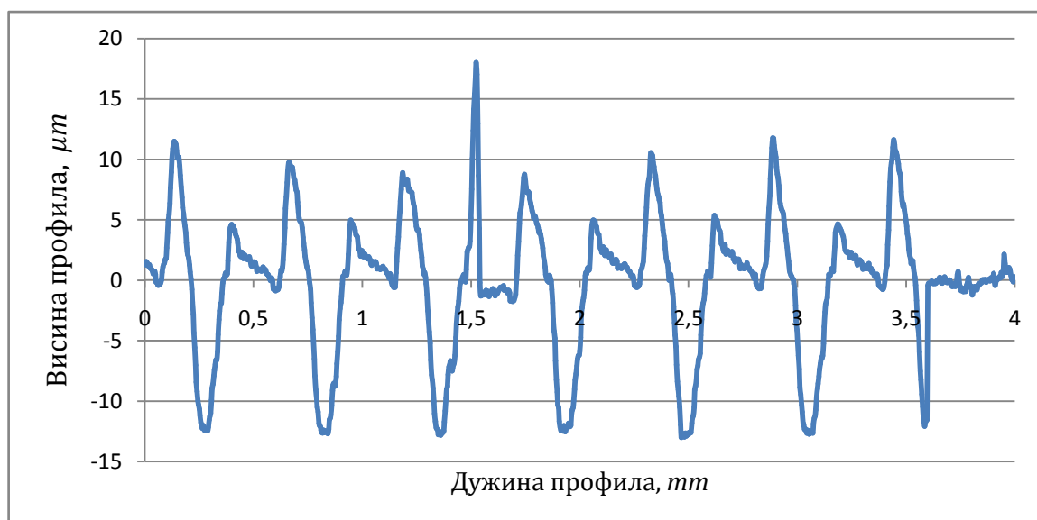
Слика 5.2 Изглед дијаграмског приказа профила површине радног комада
