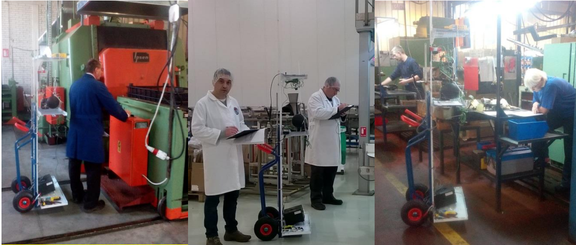
Slika 6.3. Prikaz mobilnog sistema za merenje fizičkih uslova radne sredine.
