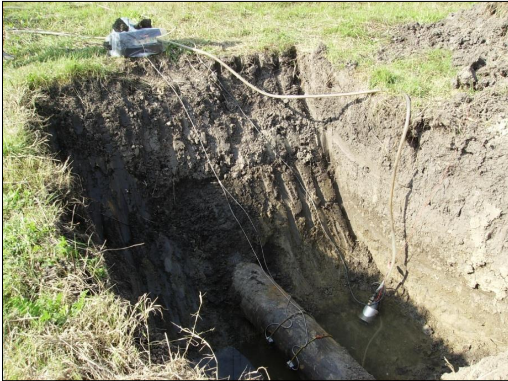
Slika 34 Merenje protoka u cilju proračuna vodnog bilansa
