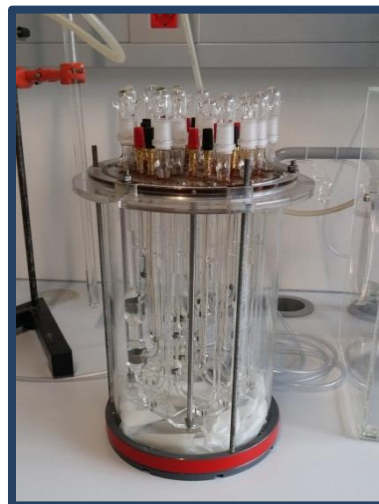
Slika 3.7. Sklop od devet ćelija za simultano merenje provodljivosti koncentrovanih rastvora.
