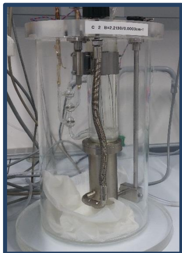
Slika 3.6. Troelektrodna ćelija za merenje provodljivosti razblaženih rastvora.
