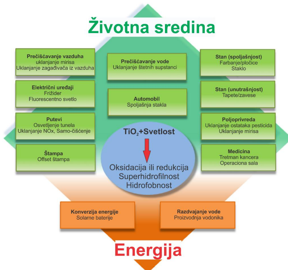
Slika 2.7. Različite primene \text{TiO}_2 fotokatalizatora [71]
