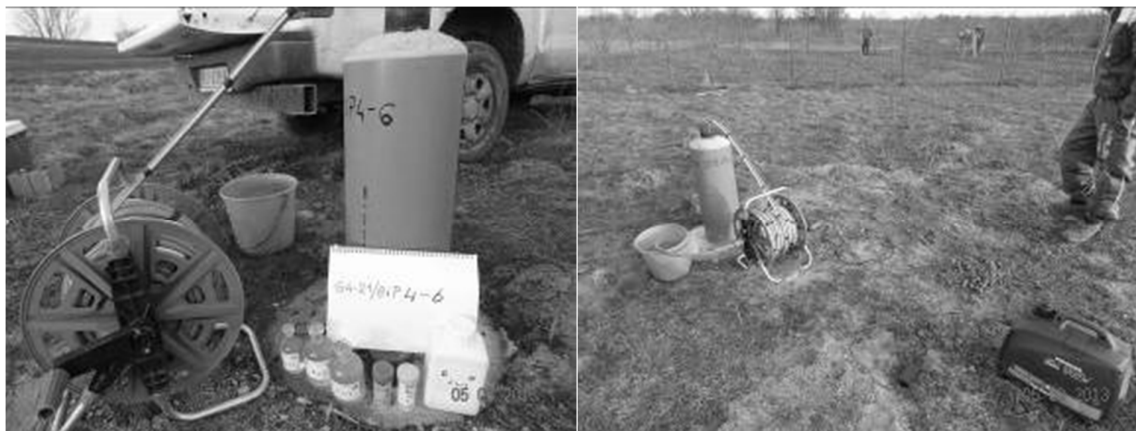
Slika 4.1 Prikaz opreme i postupka uzorkovanja podzemnih voda iz pojedinih pijezometara (Foto dokumentacija - Institut za vodoprivredu Jaroslav Černi)
