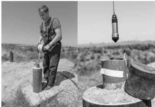
Slika 4.3 Prikaz ručnog merača nivoa i automatskog merača nivoa („diver“) podzemnih voda (Foto dokumentacija-terenski eksperiment 2014. godine)
