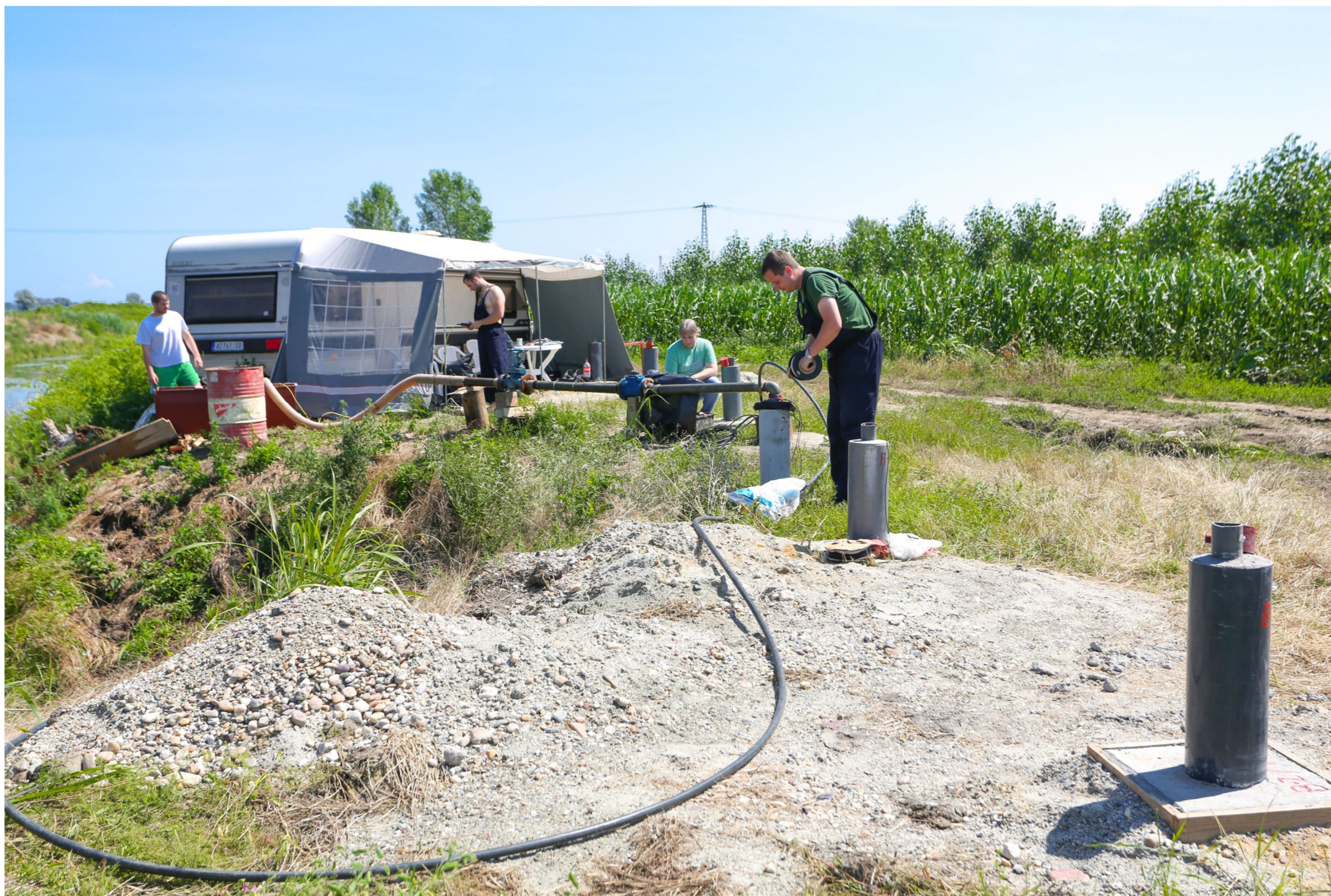
Slika 2.3 Lokacija sprovođenja terenskog eksperimenta i postavka merne opreme (Drenažni sistem Kovin-Dubovac, drenažni kanal crpna stanica Vrba, samoizlivni bunar Bp-2) (Foto dokumentacija: terenski eksperiment 2014. godine)
