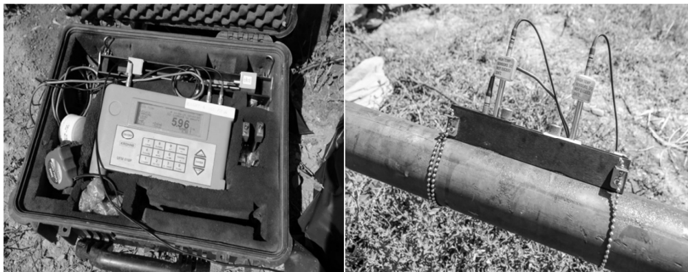
Slika 4.5 Ultrazvučno merilo protoka Nivus PCM Pro (Foto dokumentacija-terenski eksperiment 2014. godine)
