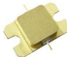
Слика П.13. - Sumitomo (бивши Fujitsu, касније Eudyna) GaN појачавач излазне RF снаге од 100 W. Транзистор у пропусном опсегу има импедансу прилагођену на 50 Ω, тако да никакво накнадно прилагођење није потребно.
