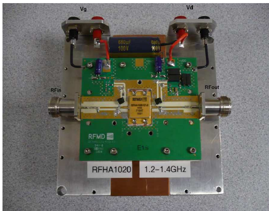
Слика П.8. - RFHA1020 280 W GaN WIDE-BAND PULSED POWER AMPLIFIER.
