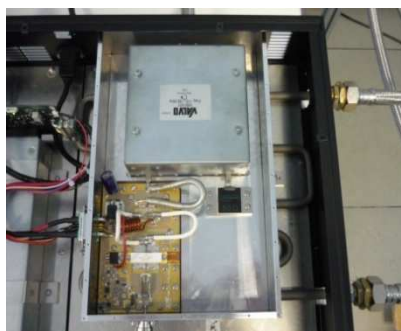
Слика 5.2. - Предајник на VHF опсегу од 1 KW.
