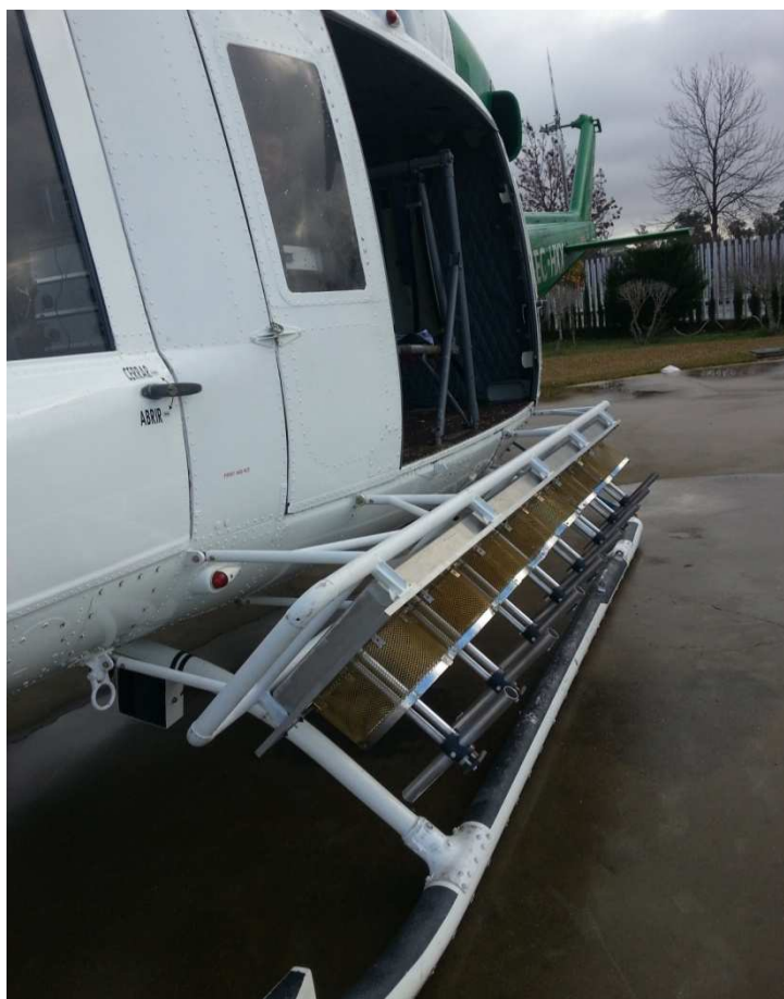
Слика 7.2. - SAR-GPR радар монтиран на летећој платформи (врло сложена обрада обављена на једном Cyclon IV процесору).
