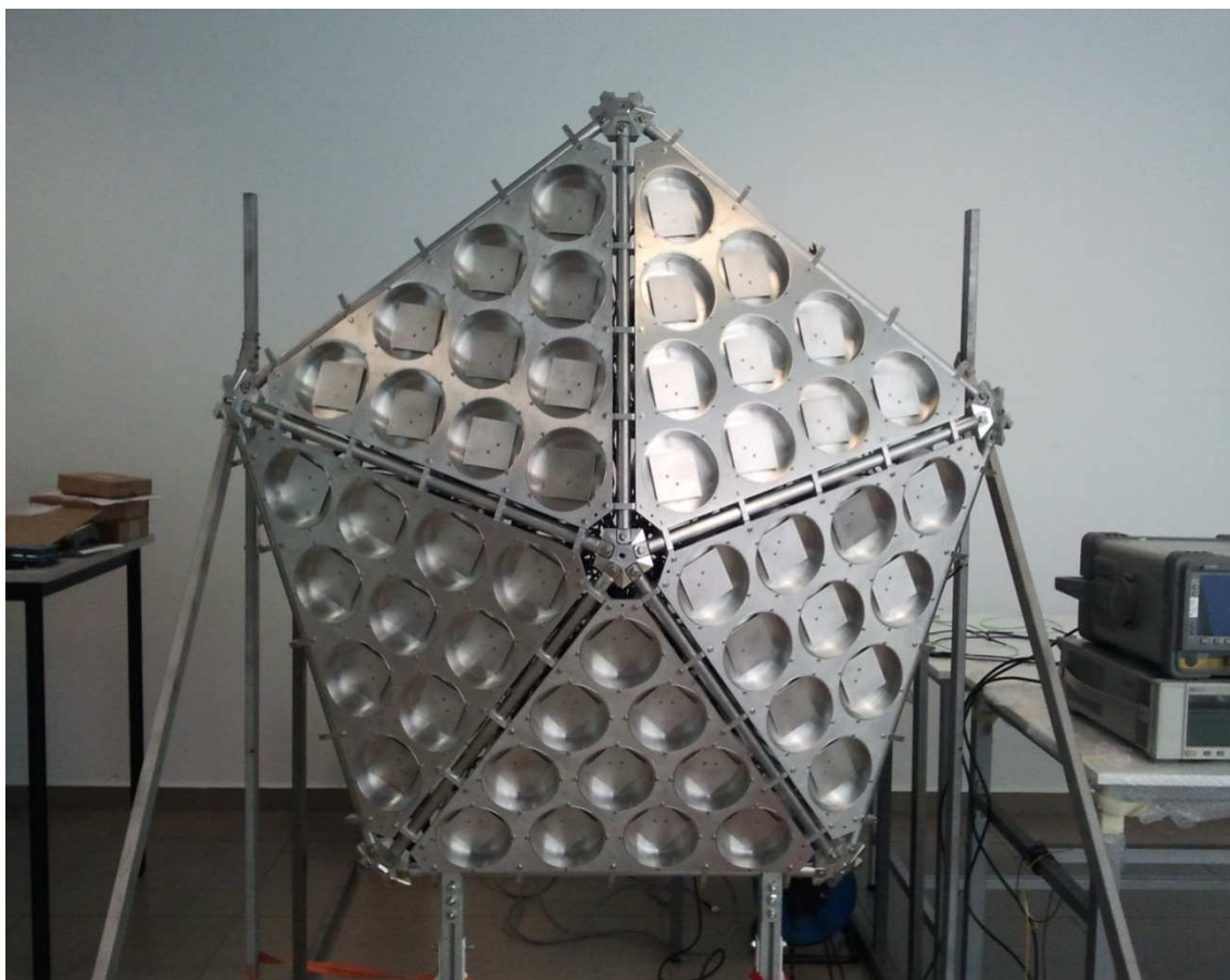
Слика 7.13. - Реализовани модел антене радарског пријемника.
