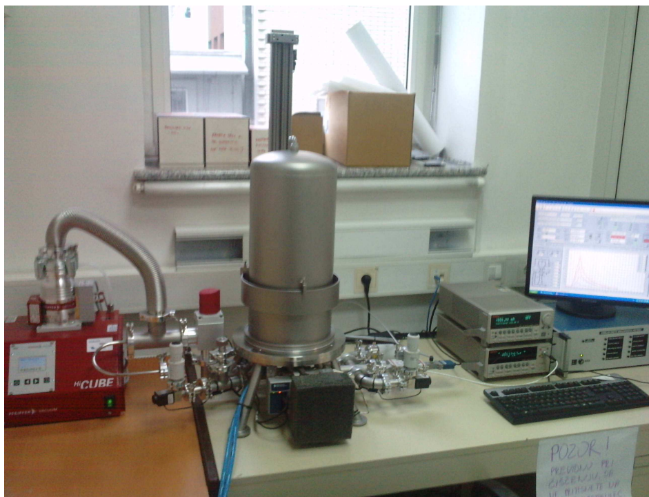
Slika 4.1. „Z-metre“ uređaj za merenje termoelektričnih svojstava u temperaturnom intervalu od 320 do 830 K.
