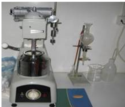
Slika 25. Amilograf Brabender PT 100, Duisburg, Nemačka
