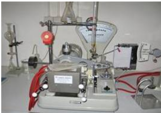
Slika 23. Farinograf Brabender, model 8 10 101, Duisburg, Nemačka
