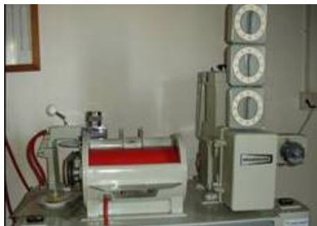
Slika 24. Ekstenzograf Brabender, model 8600-01, Duisburg, Nemačka
