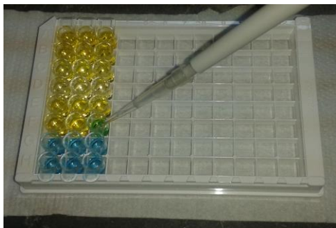
Slika 15. Dodavanje stop rastvora u velove mikrotitar ploče
