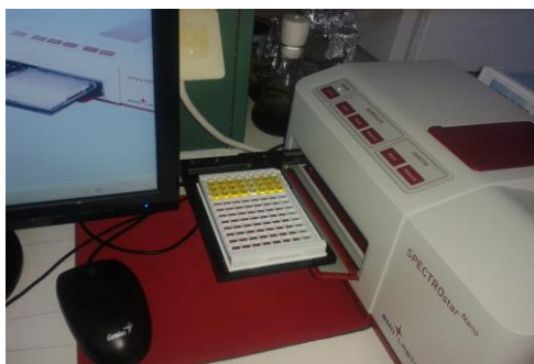
Slika 14. Očitavanje apsorbance na 450 nm pomoću čitača mikrotitar ploča
