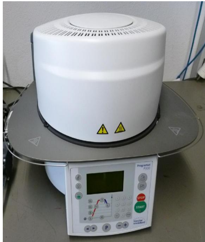
Slika 7. Keramička peć u kojoj su glazirani eksperimentalni uzorci
