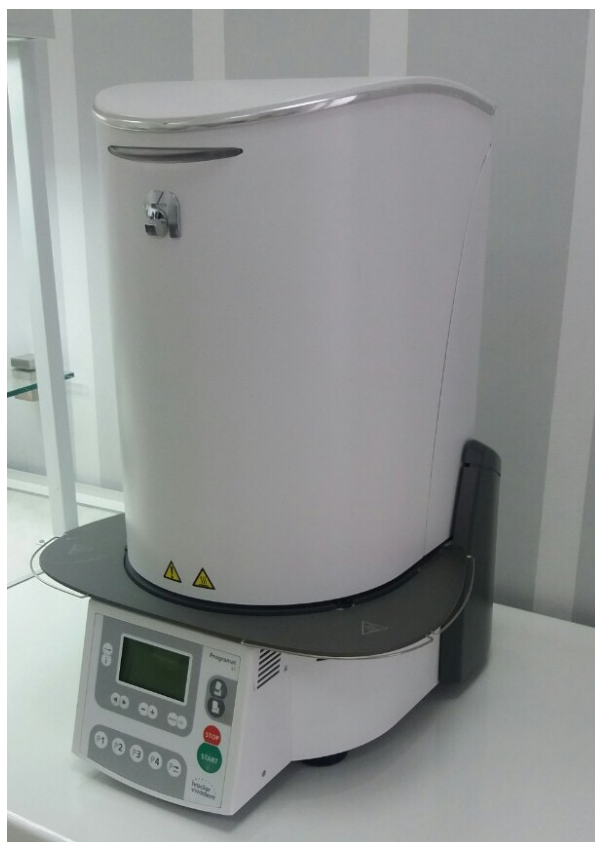
Slika 5. Peć za sinterovanje oksidne keramike
