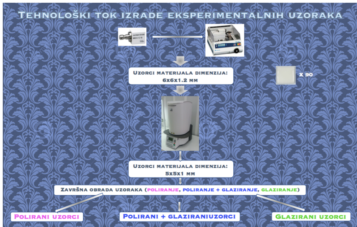
Slika 1. Šematski prikaz izrade eksperimentalnih uzoraka
