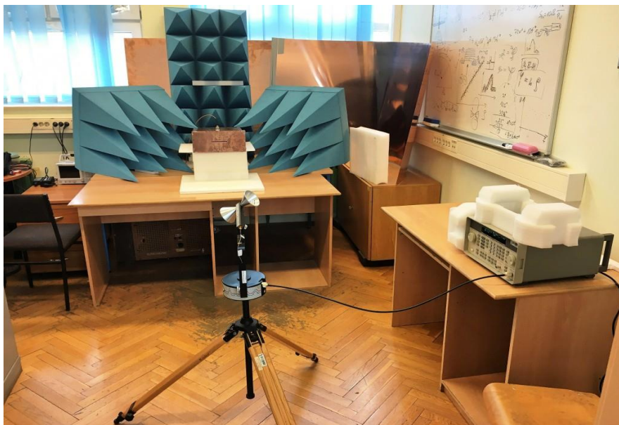
Slika 5.7 Merno mesto sa opremom za merenje tačka po tačka i predajnom antenom bikonusni dipol
