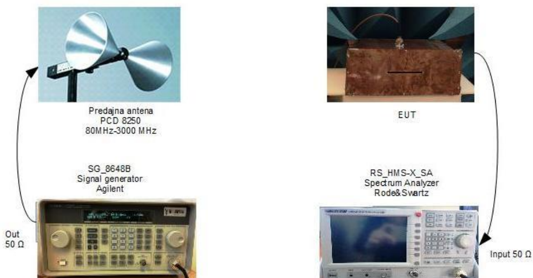
Slika 5.9 Konfiguracija za merenje tačka po tačka
