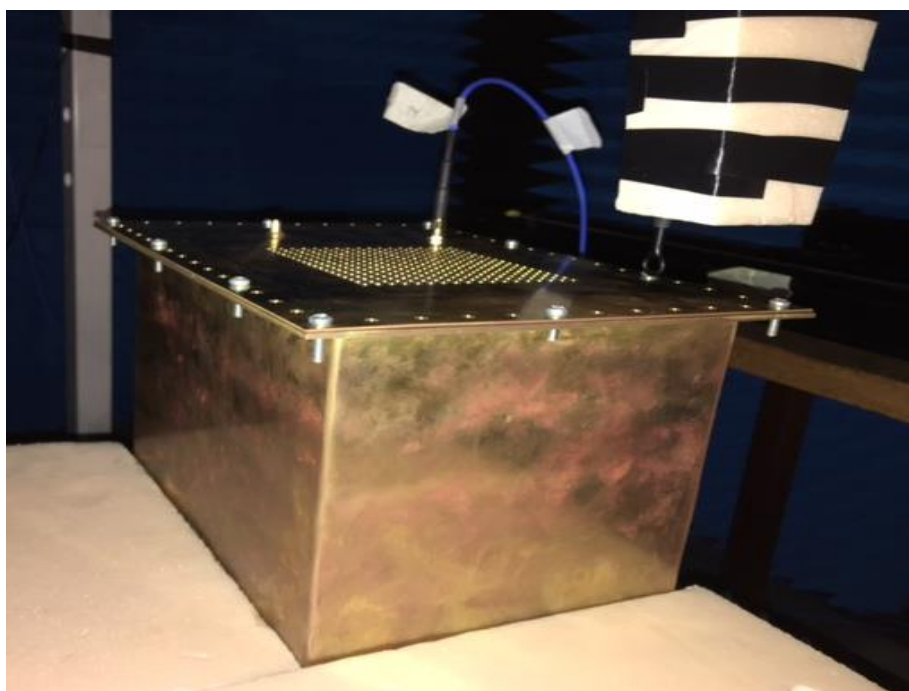
Slika 6.11 Pokretna RF sonda za detekciju EM polja iznad kućišta u kome je pobuđena jedna monopol antena
