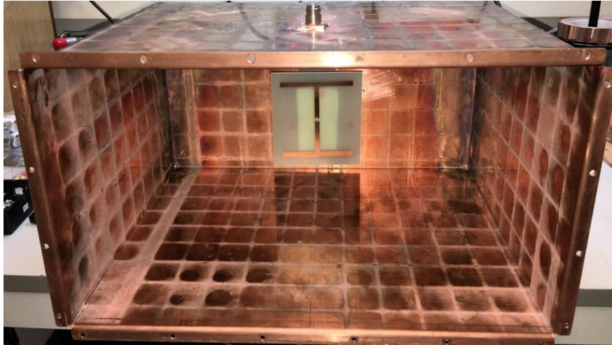
Slika 7.2 Fotografija štampane dogbone antene u mernom kućištu
