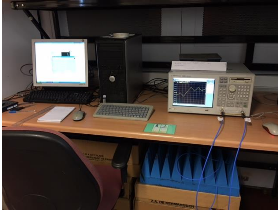
Slika 6.12 Eksperimentalna postavka (računar sa LabVIEW softverom i VNA)
