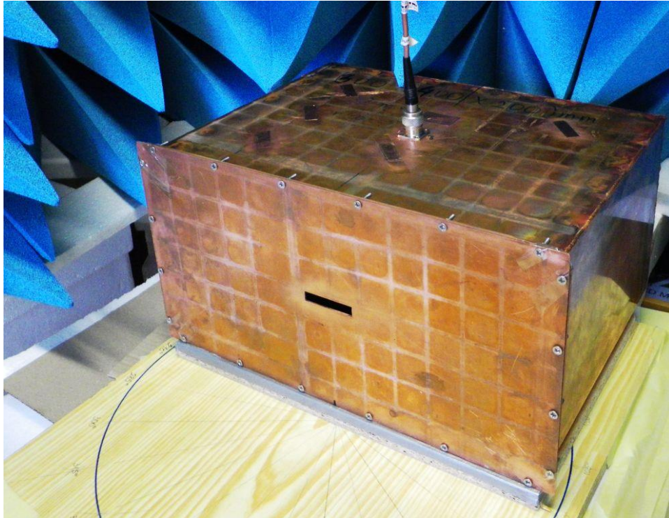
Slika 5.42 Fizička realizacija kućišta BM sa pravougaonim otvorom.
