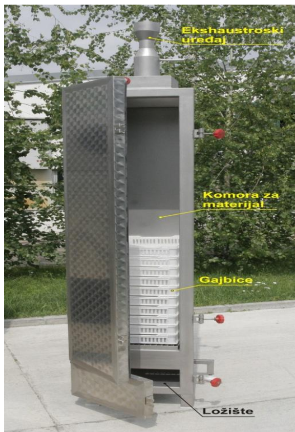
Slika 5.3. Namjenska komora za sumporisanje voća KS 80 (Babić, M, 2011)
