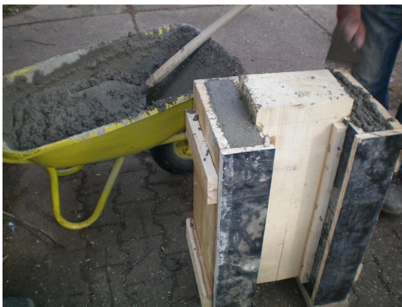
Slika 5.6. Izrada uzoraka za ispitivanje modula pomeljivosti veze
