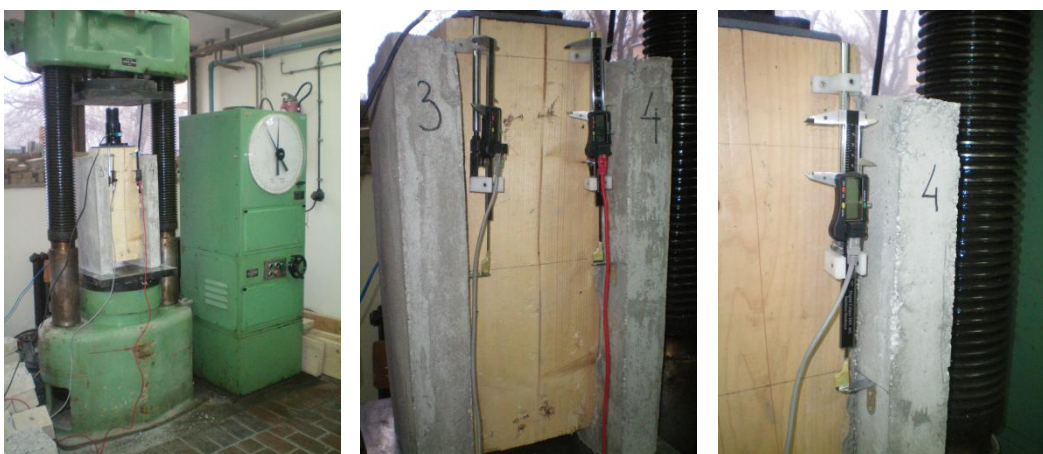
Slika 4.25. Položaj pomičnih merila na modelu i ispitivanje modela
