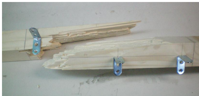
Slika 4.18. Izgled uzorka nakon loma
