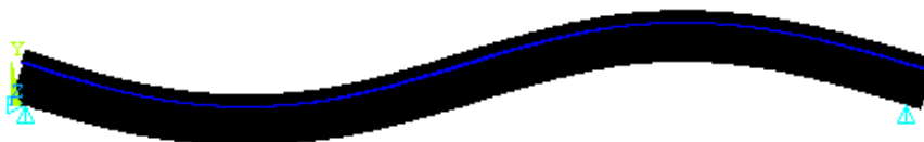
b) Drugi karakteristični oblik oscilovanja - Mod 2 grede G1
