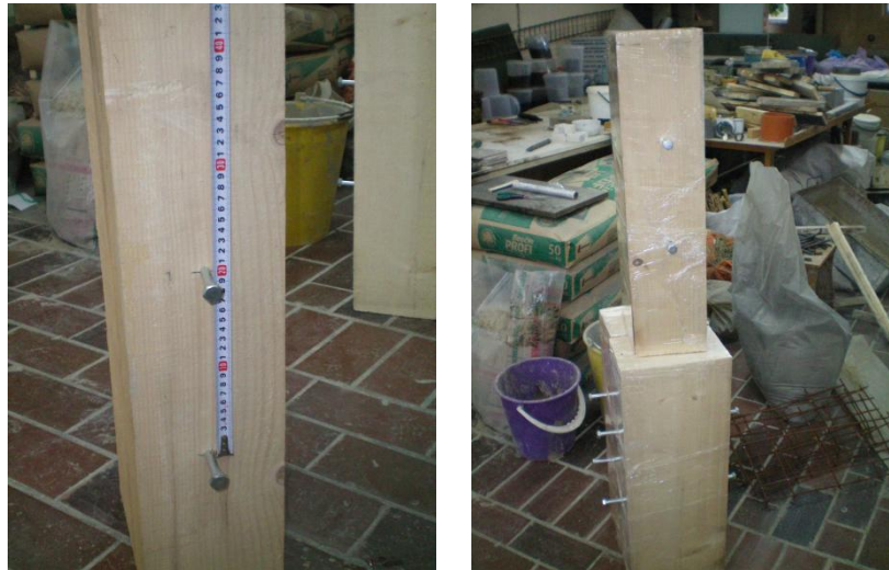
Slika 4.23. Izgled drvenog dela modela sa ugrađenim spojnim sredstvima
