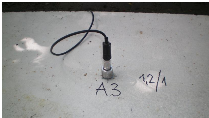
Slika 5.9. Postavljanje akcelerometra na merno mesto
