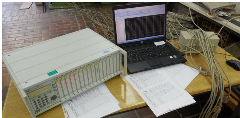
Slika 3.51 Sistem za digitalnu akviziciju podataka sa mernih traka
