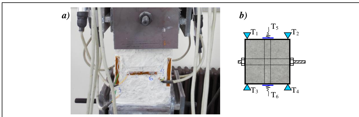
Slika 3.46 a) Merne trake na betonu b) Raspored mernih traka na poprečnom preseku
