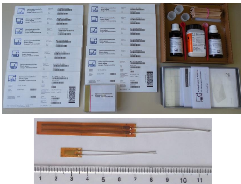
Slika 3.48 Merne trake, lepak X-60 i zaštitna obloga ABM75
