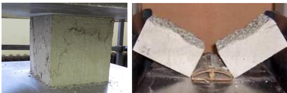
Slika 3.18 Ispitivanje čvrstoće betona na pritisak i zatezanje cepanjem
