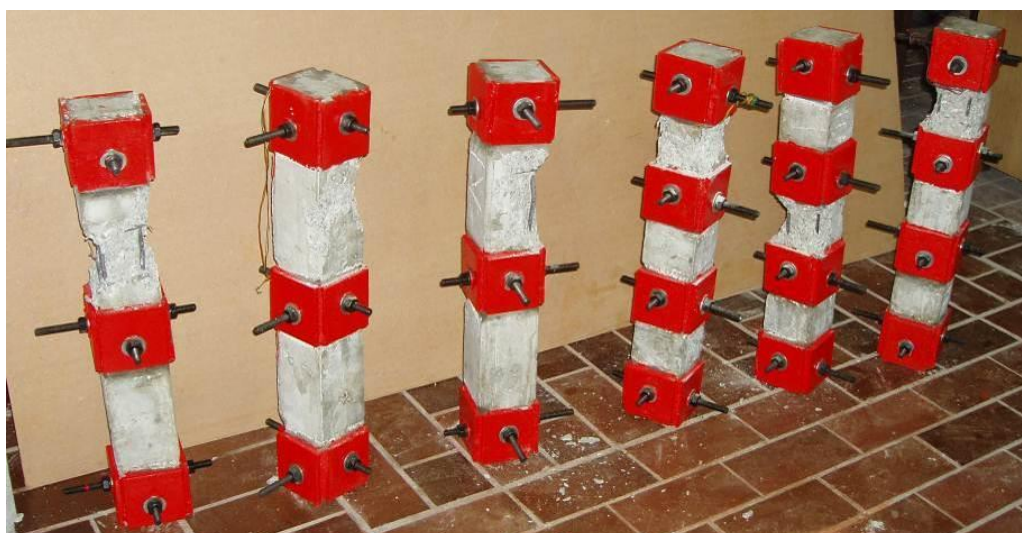
Slika 2.15 Modeli stubova sa ojačanjem neposredno nakon ispitivanja
