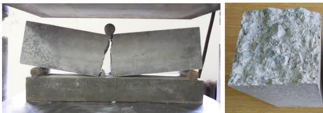
Slika 3.19 Ispitivanje čvrstoće betona na zatezanje pri savijanju
