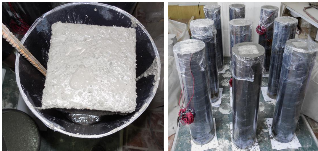
Slika 3.13 Detalj ugradnje i prikaz gotovih modela stubova ispunjenih Polimagom
