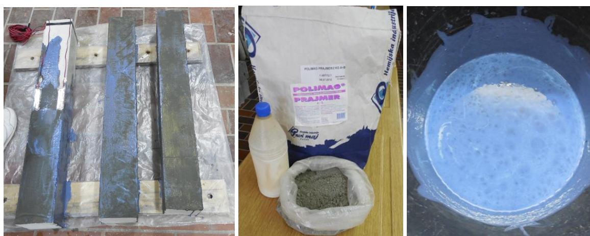
Slika 8.5 Priprema uzoraka premazivanjem Polimag-Prajmerom, pakovanje i mešanje
