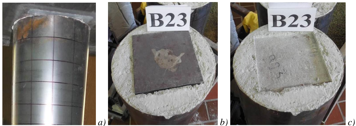
Slika 4.18 Vrh modela stuba B23 neposredno nakon ispitivanja
