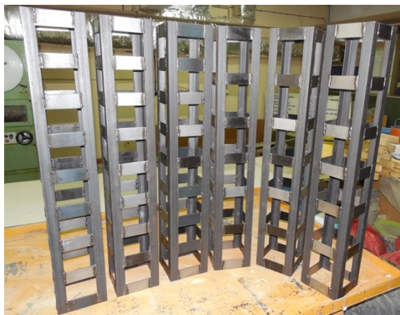
Slika 3.39 Stubovi složenog poprečnog preseka
