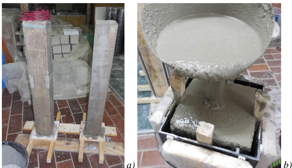
Slika 3.14 a) Priprema uzoraka premazivanjem SikaLatex emulzijom b) Detalj ugradnje SikaGrouta
