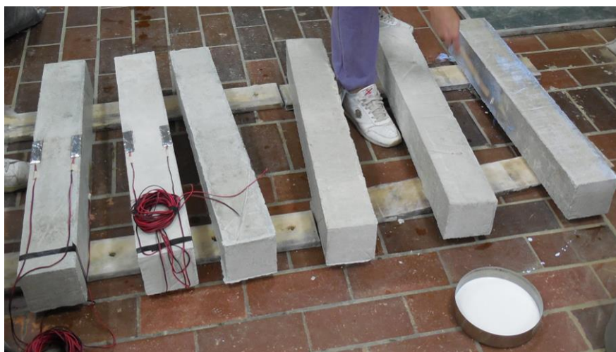
Slika 8.4 Priprema modela premazivanjem SN vezom
