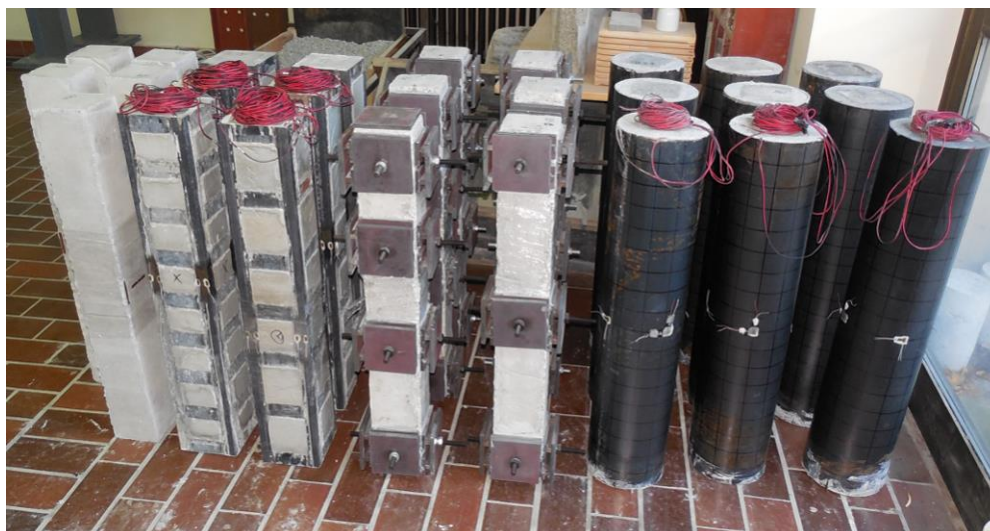
Slika 3.53 Modeli stubova neposredno pre ispitivanja
