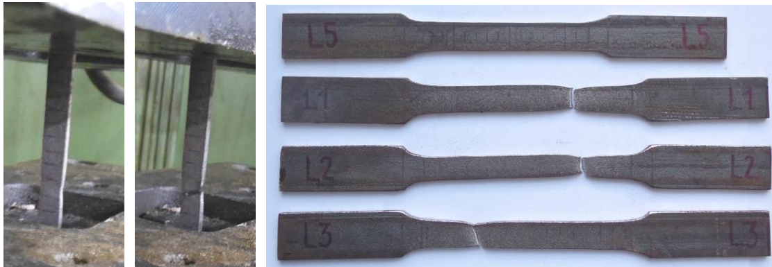
Slika 3.41 Ispitivanje mehaničkih karakteristika čelika L profila
