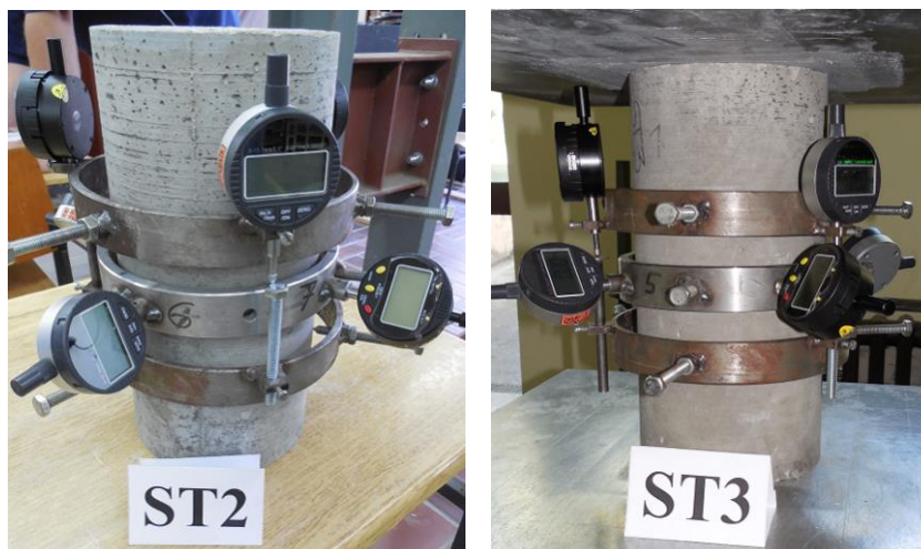
Slika 3.20 Oprema i merenje dilatacija za određivanje statičkog modula elastičnosti
