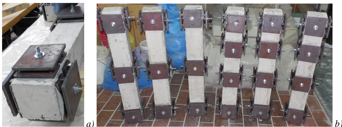
Slika 3.17 a) Sklop metalnih pločica pritegnut privremenim zavrtnjima, b) Modeli stubova nakon lepljenja prenosnih pločica
