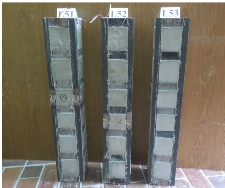
Slika 4.59 Modeli ojačanih stubova L5x neposredno posle ispitivanja
