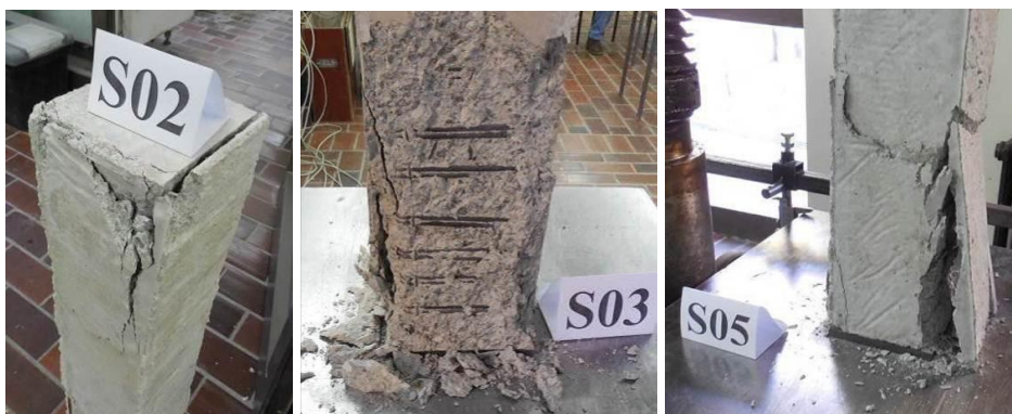
Slika 4.8 Karakterističan oblik pri lomu modela stubova kontrolne grupe
