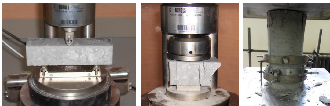
Slika 3.28 Ispitivanje mehaničkih karakteristika Polimag-a
