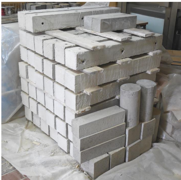
Slika 3.11 Pripremljeni modeli AB stubova i kontrolni uzorci
