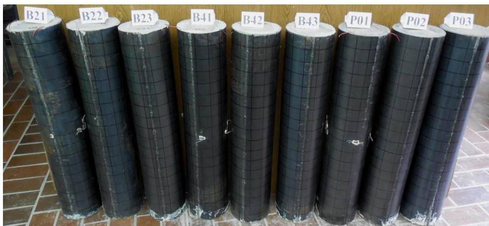
Slika 4.83 Modeli stubova ojačani čeličnim plaštom
