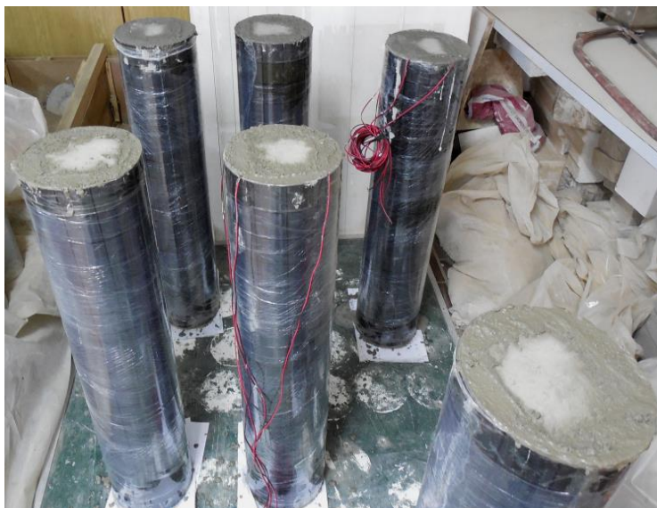
Slika 3.12 Modeli stubova ispunjeni sitnozrnim betonom
