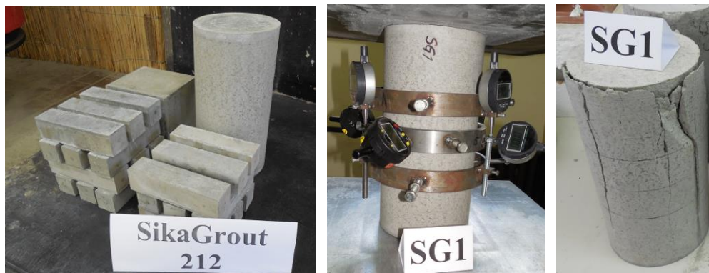
Slika 3.31 Kontrolni uzorci i ispitivanje mehaničkih karakteristika
