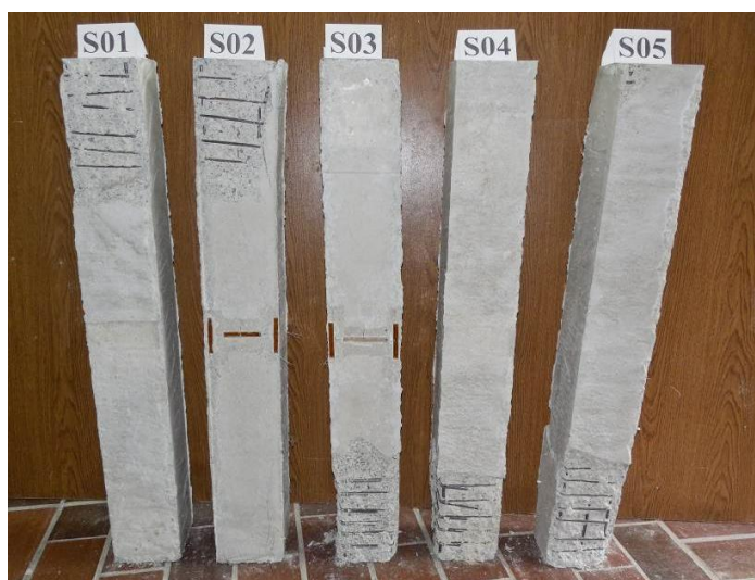
Slika 4.9 Modeli kontrolnih stubova nakon ispitivanja
