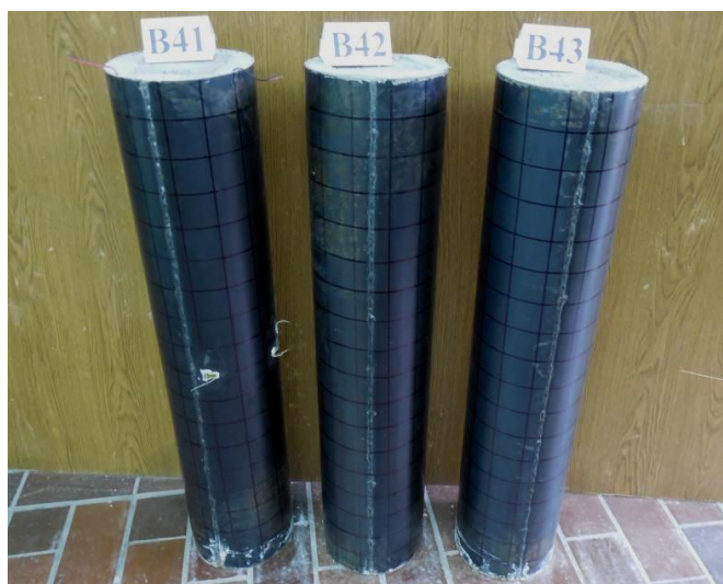
Slika 4.28 Modeli ojačanih stubova B4x neposredno posle ispitivanja
