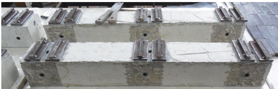
Slika 3.16 Modeli stubova za zalepljenim pločicama
