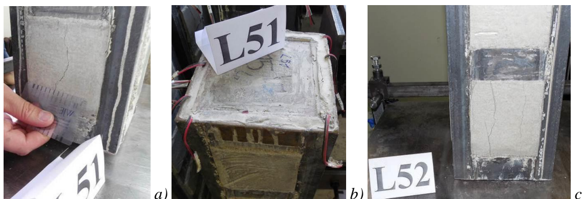
Slika 4.58 Krajevi modela stuba L51 i L52 nakon ispitivanja
