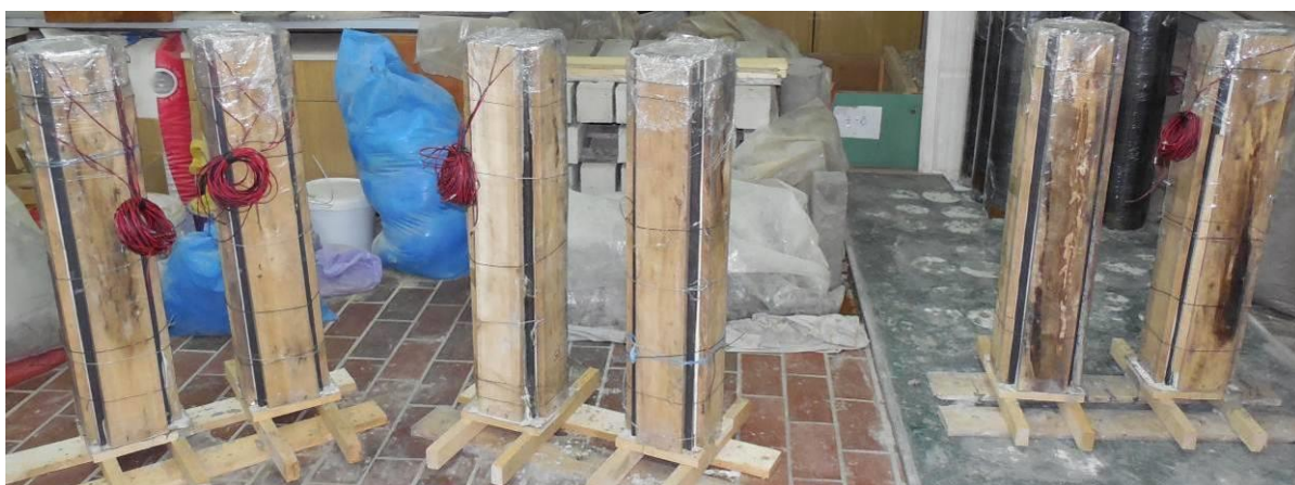
Slika 3.15 Modeli stubova nakon betoniranja ispune
