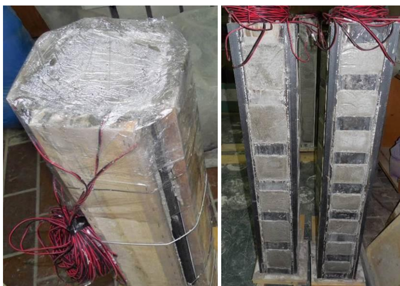
Slika 8.6 Zaštita stuba od gubljenja vlage i prikaz gotovih modela nakon skidanja oplate
