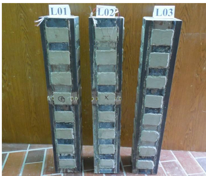
Slika 4.48 Modeli ojačanih stubova L0x neposredno posle ispitivanja
