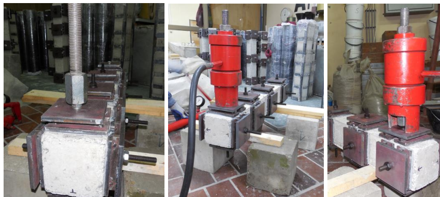
Slika 8.10 a) Detalj hvataljke montirane na VV zavrtnanj, b) c) Hidraulični uređaj pripremljen za istezanje zavrtnja
