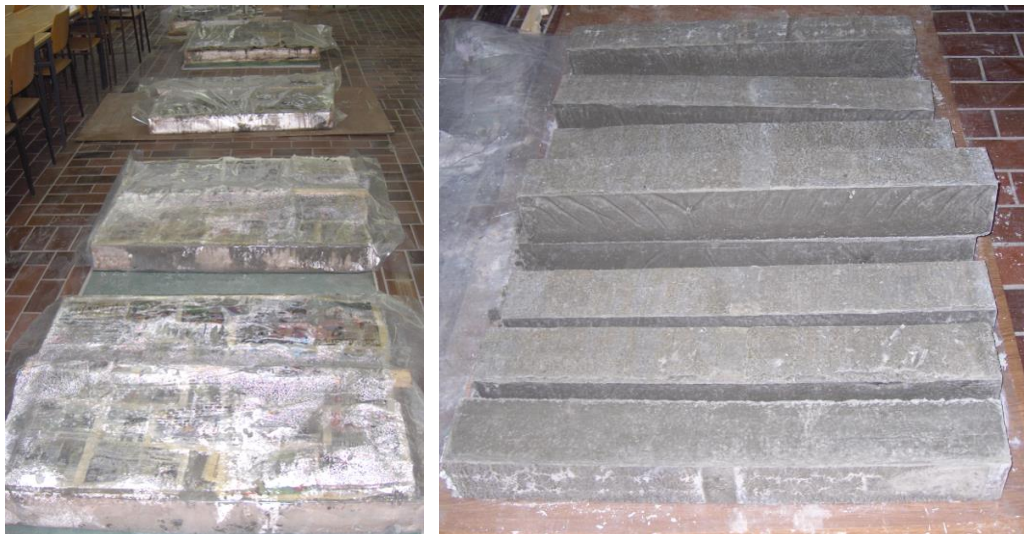
Slika 8.3 Izbetonirani modeli i stubovi nakon skidanja oplata
