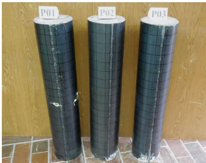
Slika 4.37 Modeli ojačanih stubova P0x neposredno posle ispitivanja
