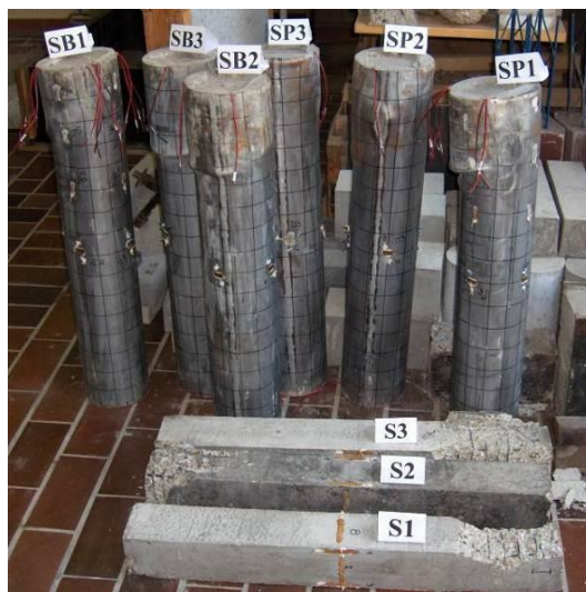
Slika 2.11 Modeli stubova neposredno nakon ispitivanja
