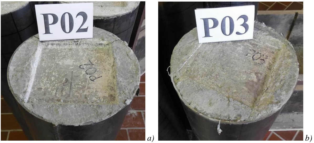
Slika 8.19 Vrh modela stubova nakon ispitivanja
