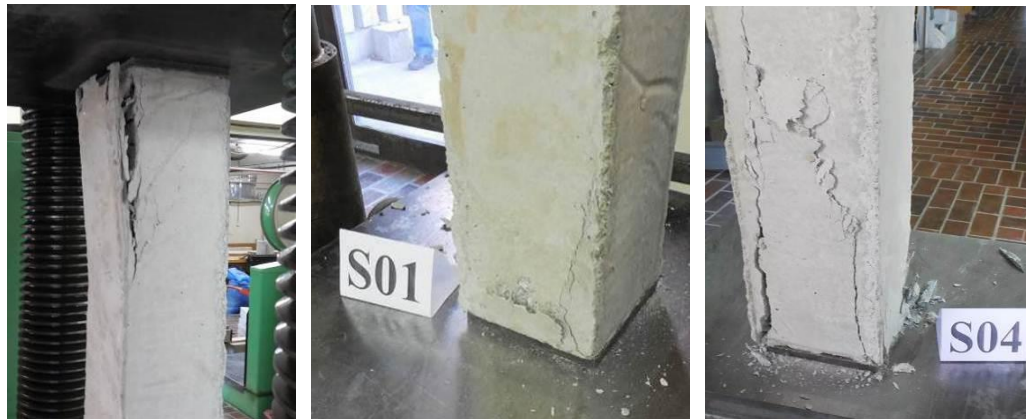
Slika 8.12 Karakterističan oblik pri lomu modela stuba S01 i S04
