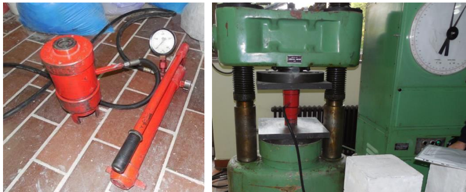
Slika 8.9 a) Hidraulični uređaj za pritezanje zavrtnjeva b) Kontrolno baždarenje
