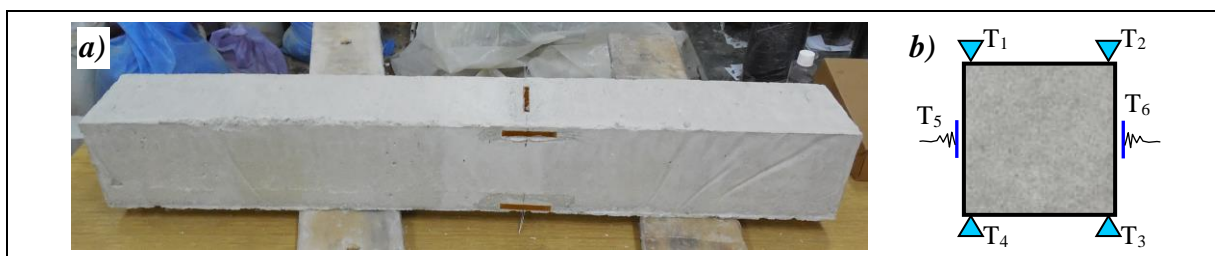
Slika 3.43 a) Merne trake na AB stubu b) Raspored mernih mesta na poprečnom preseku
