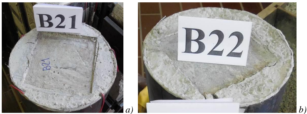
Slika 8.14 Vrhovi modela stubova B21 i B22 nakon ispitivanja
