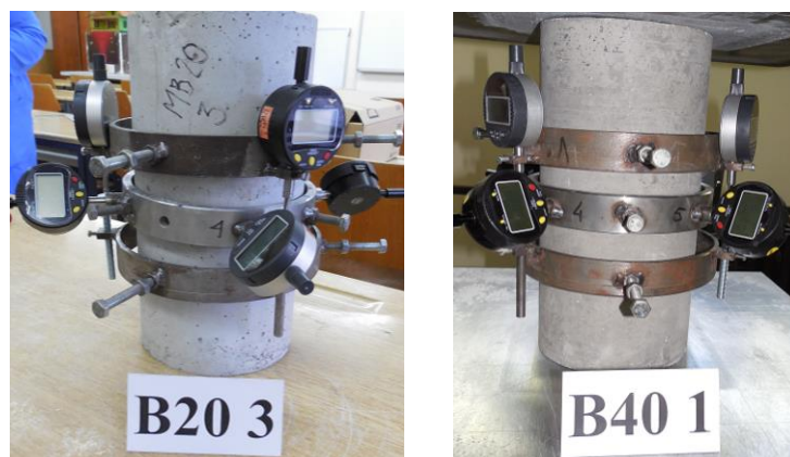
Slika 3.24 Određivanje statičkog modula elastičnosti pri pritisku
