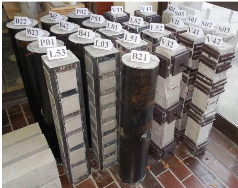
Slika 4.79 Modeli stubova neposredno nakon ispitivanja
