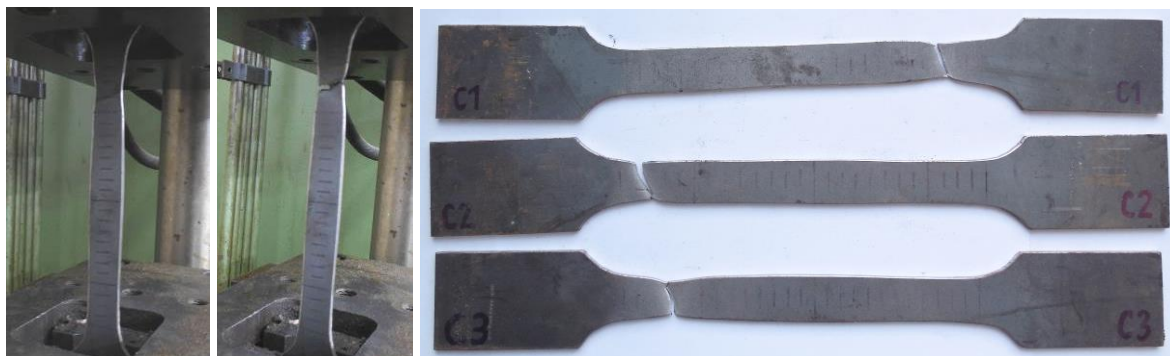
Slika 3.38 Ispitivanje mehaničkih karakteristika čelika
