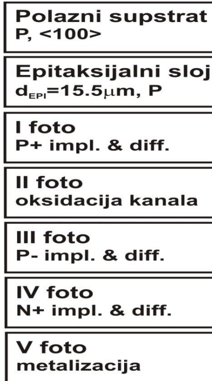
Slika 4.1. Redosled važnijih tehnoloških procesa i foto-postupaka u postupku proizvodnje n-kanalnog VDMOS tranzistora snage IRF510 [59,81,146].
