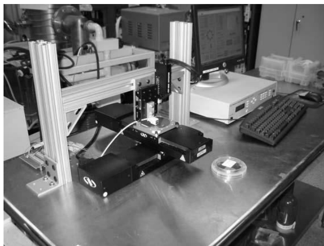
Slika 3.4.10. Prikaz mernog sistema za merenje električne otpornosti u 4 tačke
