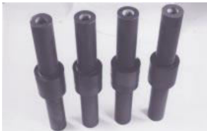
Slika 3.2.5. Keramičke cevi i spojevi [14]
