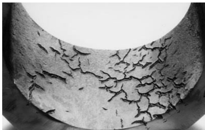
Slika 3.3.5. Termički zamor materijala i cementacija u kolenu
