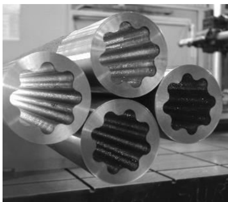
Slika 3.2.2. Cevi (Inco) od legure 803 sa unutrašnjim rebrima (cevi se takođe proizvode i sa spiralnim rebrima (Inco i Sumitomo) za novije peći sa kraćim zadržavanjem procesnog fluida)
