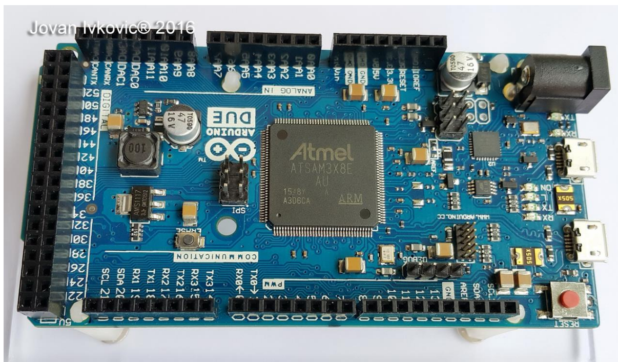
Ilustracija 57. Arduino DUE sa Atmel SAM3X8E 32-bitni ARM Cortex –M3 mikrokontrolerom
