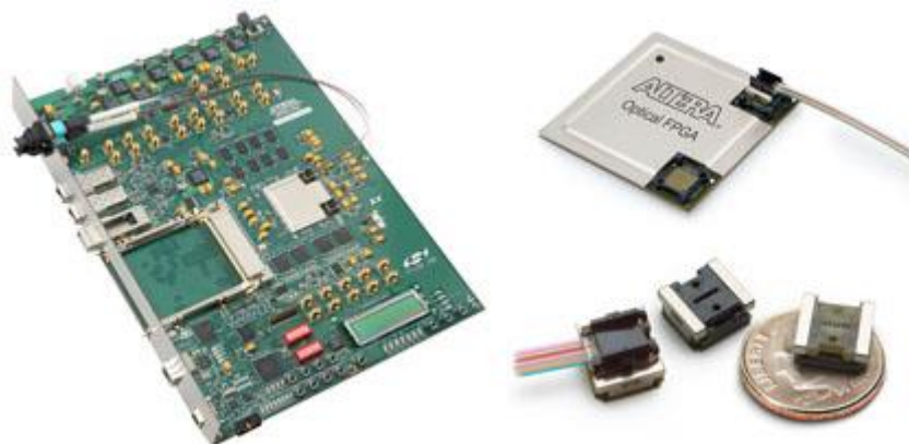
Ilustracija 40. Prvi primer integracije Altera Stratix IV GT FPGA plus dva Avago Technologies MicroPOD optička modula [105]
