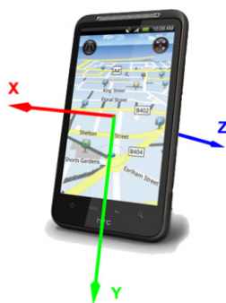
Slika 4.1 Orijehtacija osa integrisanog akceleracionog senzora
