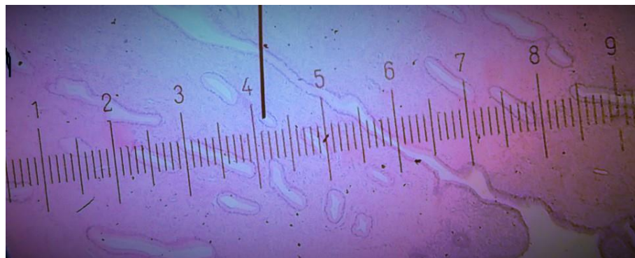
Slika 18. Linearni mikrometar postavljen u okular mikroskopa
