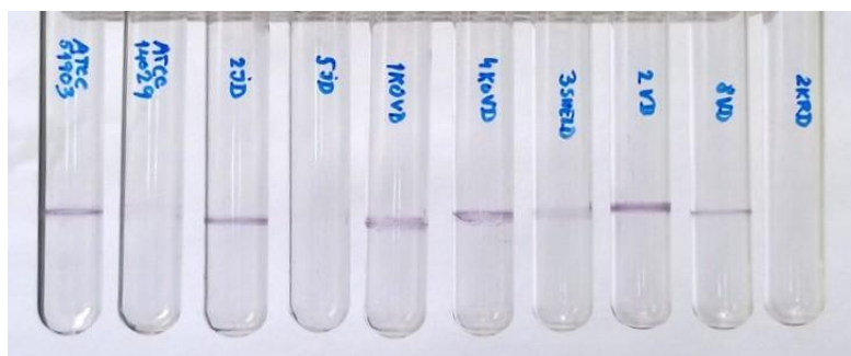
Slika 4.4 Kvalitativna procena sposobnosti produkcije biofilma sojeva P. shigelloides na površini od borosilikata
