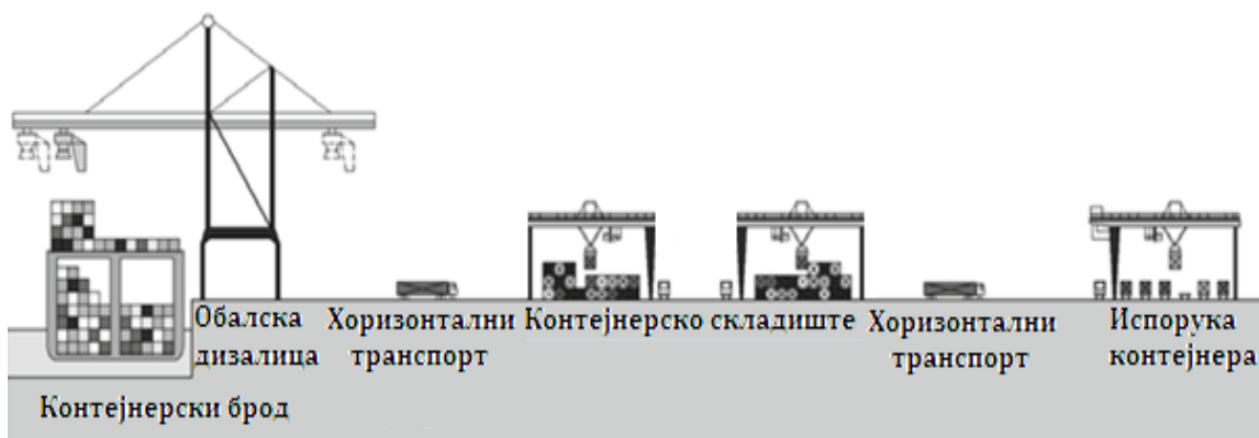
Слика 2.6. Попречни пресек контејнерског терминала са оперативним подсистемима (РТГ дизалица и терминалски трактор)
