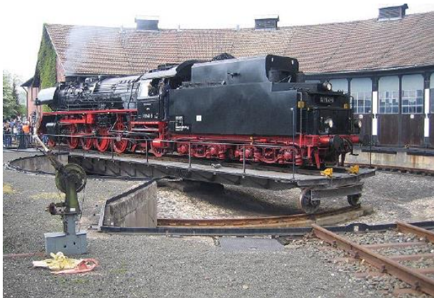
Сл.85. конструкција за ротацију возова (фотографија преузета из рада А. Фотиадоу на страни 51, за додатне информације о поменутом раду погледати фусносту 143 )
