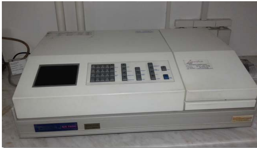
Slika 15. UV/Vis spektrofotometar (CECIL, Aquarius CE 7200, laboratorija Instituta za vode u Bijeljini)
