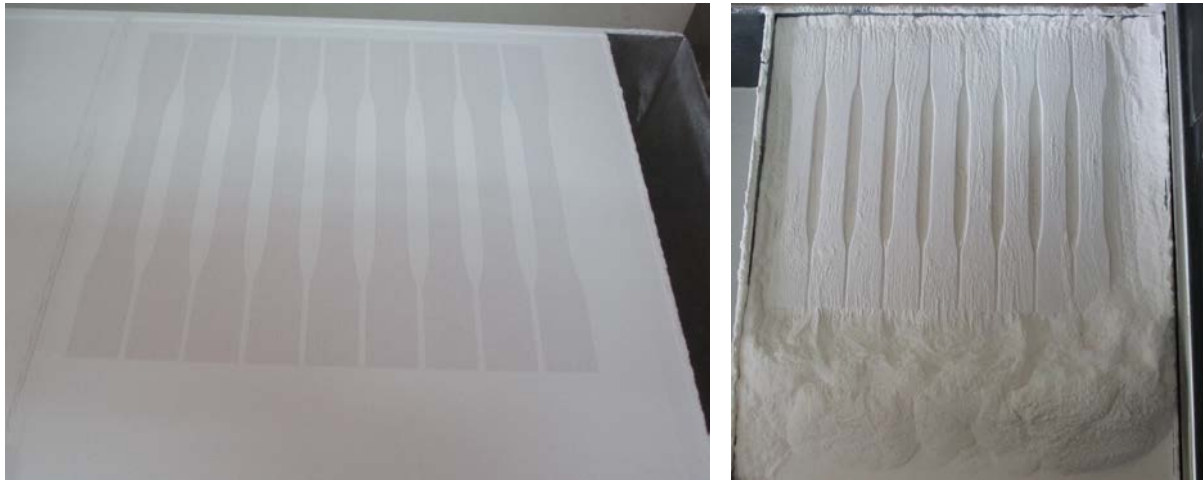
Slika 10.3 Izrada epruveta tehnologijom vezivne 3D štampe a) prikaz jednog sloja, b) neočišćene epruvete u radnom prostoru štampača
