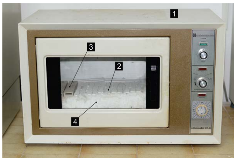
Slika 10.20 Predgrevanje epruveta: (1) peć-sušara, (2) epruvete, (3) kutije za transport epruveta i (4) kamena vuna
