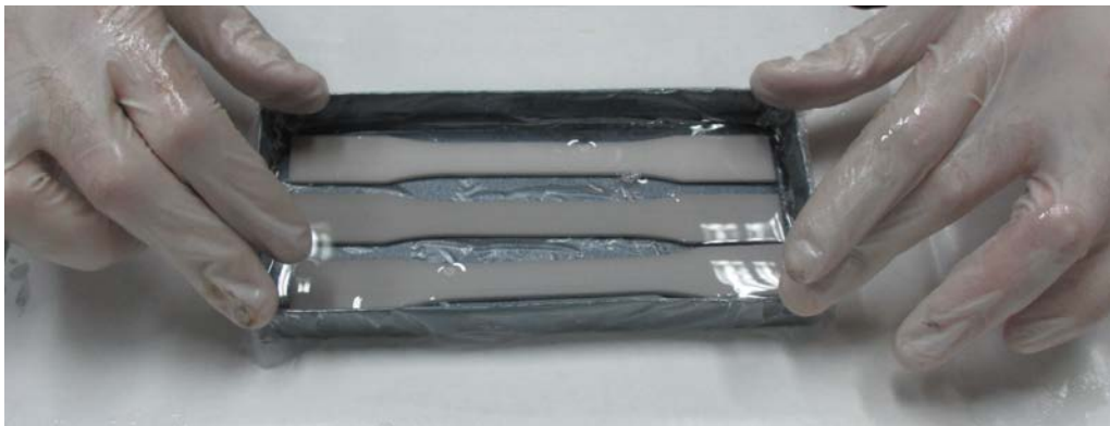
Slika 10.13 Infiltracija epruveta uranjanjem u epoksidni infiltrant
