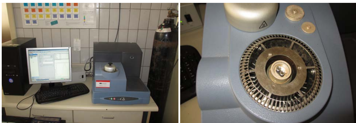
Slika 10.17 Digitalni skenirajuću kalorimetar a) Q20 (TA Instruments, USA) i b) unutrašnjost uređaja sa postavljenim kivetama
