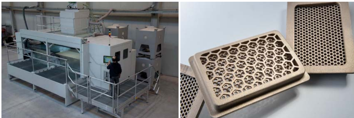
Slika 5.7 Primena vezivne 3D štampe u industriji; a) industrijski uređaj i b) primer izrađenog metalnog dela [74]
