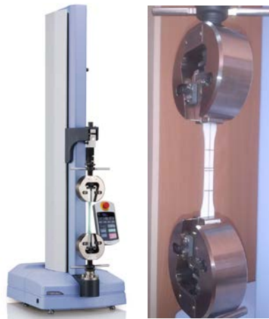
Slika 10.14 Uređaj za ispitivanje zatezne čvrstoće a) Shimadzu EZ-LX HS i b) epruveta postavljena u čeljusti
