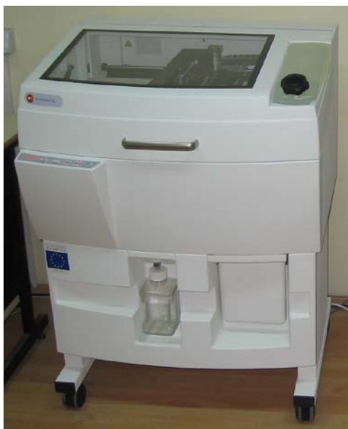
Slika 10.2 Uređaj za vezivnu 3D štampu Z310 plus i tehničke karakteristike
