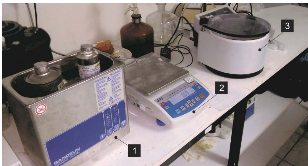
Slika 10.22 Oprema korišćena u eksperimentu sa vakuumskom infiltracijom: (1) Ultrazvučno kupatilo Bandelin Sonorex Digital, Nemačka, (2) digitalna vaga Radwag 2100/C/2, Poljska, (3) vakuum komora CitoVac, Struers, Danska
