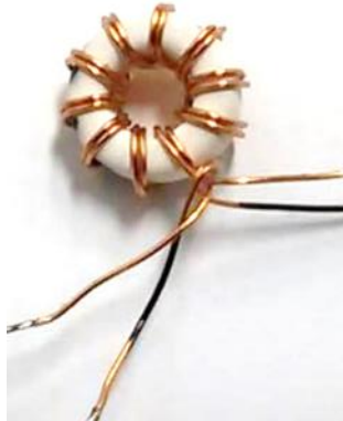
2.7 Torusno jezgro sa bifilarnim namotajima.
