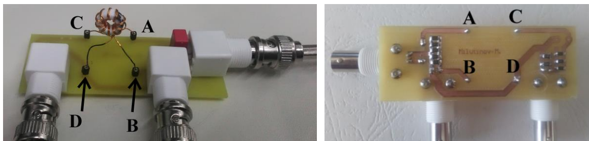
3.13 (a) Štampana ploča sa ispitivanim jezgrom i BNC konektorima. (b) Izgled štampe sa SMD otpornicima.
