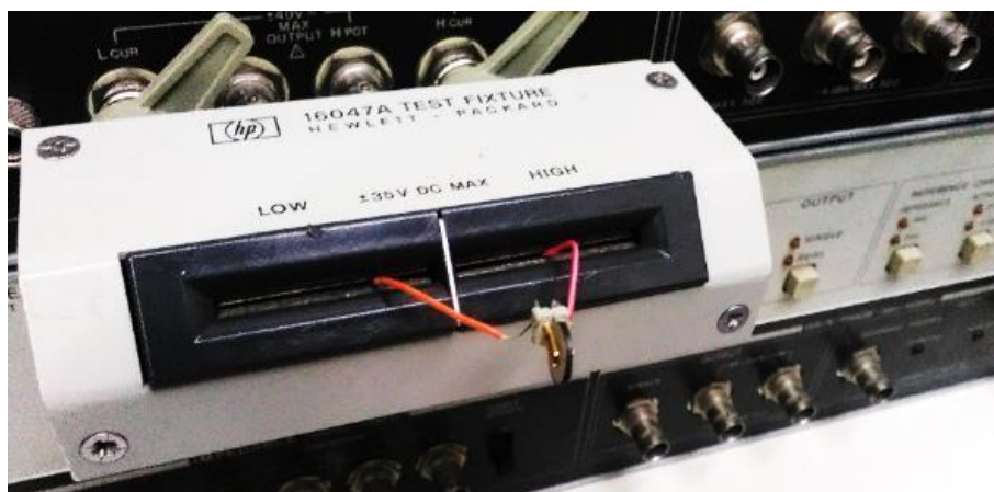
5.12 Merenje kompleksne permitivnosti uzorka pomoću instrumenta HP4194A (100Hz to 40MHz).
