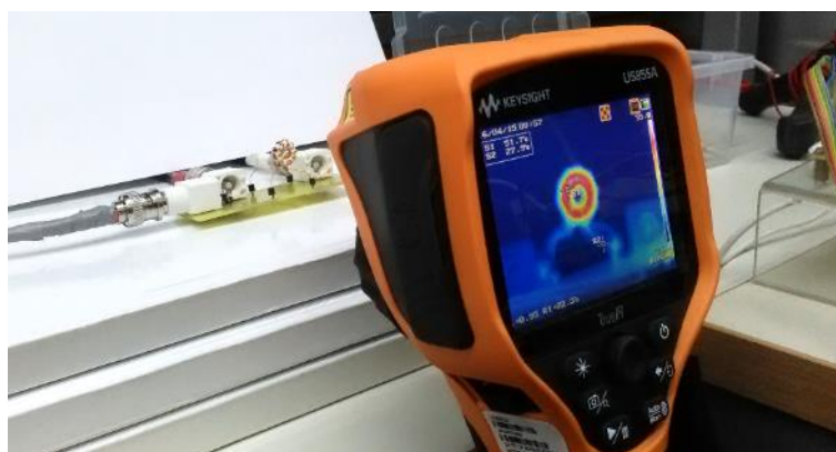
3.17 Merenje temperature jezgra termokamerom.
