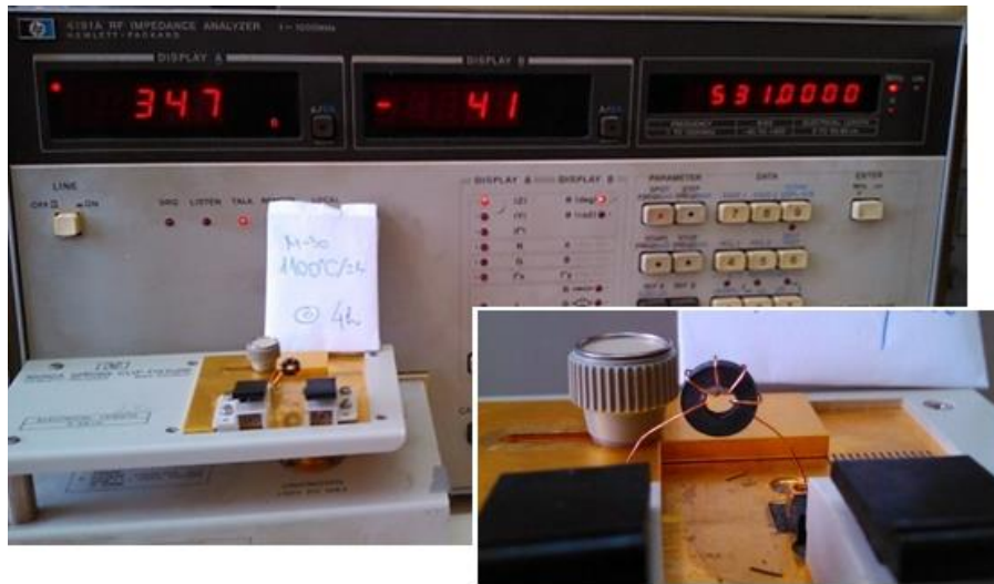
5.22 Analizator HP4191A i uveća deo dodatne pločice pomoću koje je omogućeno merenje induktivnosti pripremljenih uzoraka.
