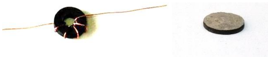
5.1 Izgled torusnog uzorka sa namotajima i uzorka u obliku diska sa metalizovanim površinama.
