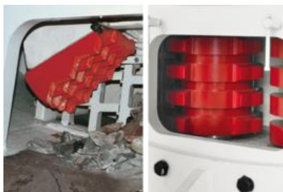
Slika 2.8. Čeljusna drobilica (levo) i rotaciona drobilica sa mešalicama (desno) ( https://www.herrenknecht.com )
