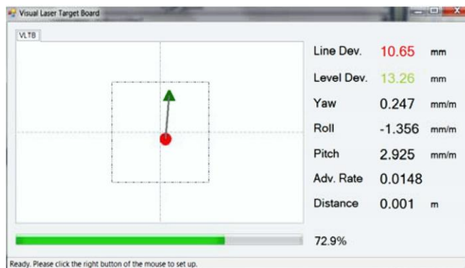
Slika 2.21. Glavni korisnički interfejs TBM-a
