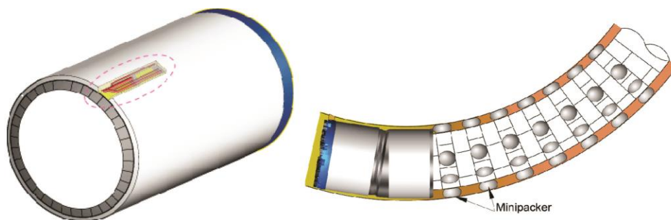
Slika 2.28. Položaj klipne pumpe u štitu TBM-a (levo); implement od maltera (minipacker) za zaptivanje segmenata betonskog prstena u zakrivljenim tunelima (desno) (tac-co.com)
