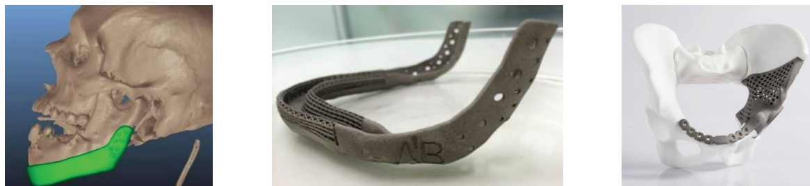
Слика 3-7. Коштани запремински модели ПИ израђени од титанијума (олакшани поступком израде): А – мандибула и Б – протеза. (EOS, 2009)
