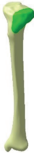
Слика 9-2. Параметарски пројектован модел кости тибиије са персонализованим имплантатом на месту дефекта (уграђен имплантат)
