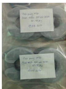
Slika 10.21. Dopunska barutna punjenja u celuloidnom kontejneru i hermetičnom polivinilskom pakovanju
