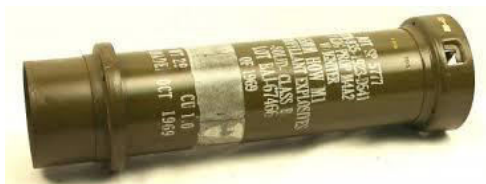
Slika 10.20. Mina za minobacač sa dopunskim punjenjima u metalnom kontejneru
