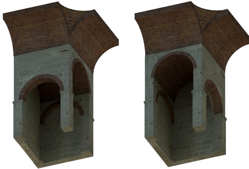
Слика 9.22. Тип сводног склопа споредног простора храма са полуобличастим сводовима који су управни на подужну осу храм и тип са полуобличастим сводовима који су паралелни са подужном осом храма
