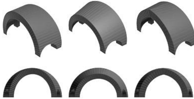
Слика 10.24. Варијанте решења свода над травејем олтарског простора (у горњем реду су перспективни прикази, а у доњем изглед свода с предње свода).
