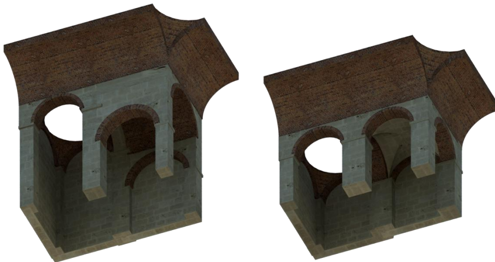
Слика 9.23. Тип сводног склопа споредног простора храма са споредним куполицама и полуобличастим сводовима који су управни на подужну осу храма и тип са споредним куполицама или кугластим сводовима у комбинацији са крстастим сводовима.
