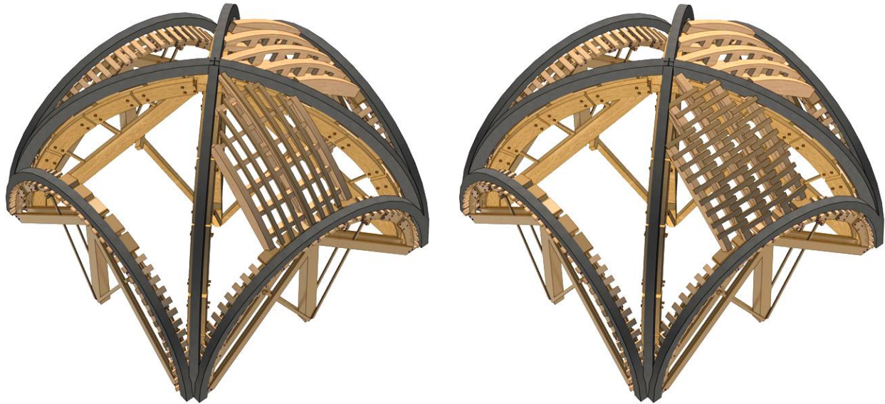
Слика 10.14. Два начина слагања дашчане оплате за зидање горње зоне свода (цртеж И. Бјелића).
