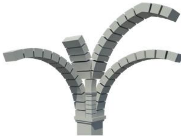
Слика 10.21. Детаљ слога сводара конструкције поткуполних лукова у цркви Св. Апостола у Пећи дат у перспективном пресеку (респективно).
