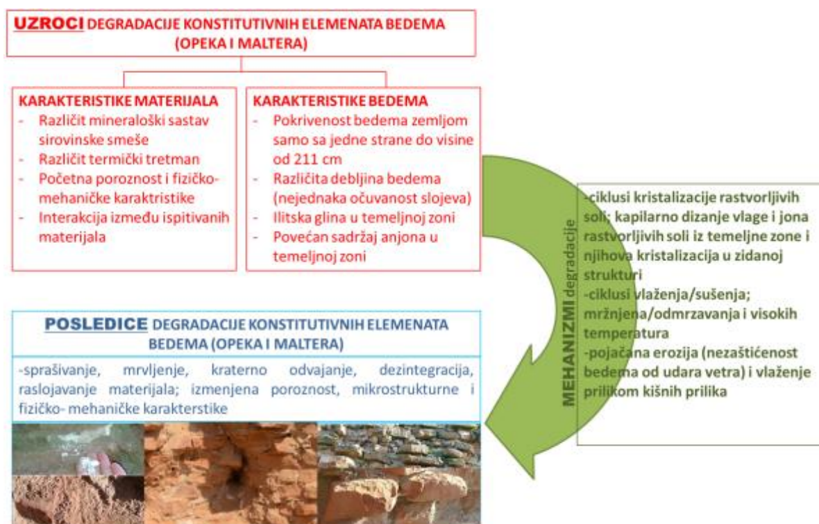
Slika 48. Uzroci, posledice i mehanizmi degradacije prisutni na severoistočnom bedemu
