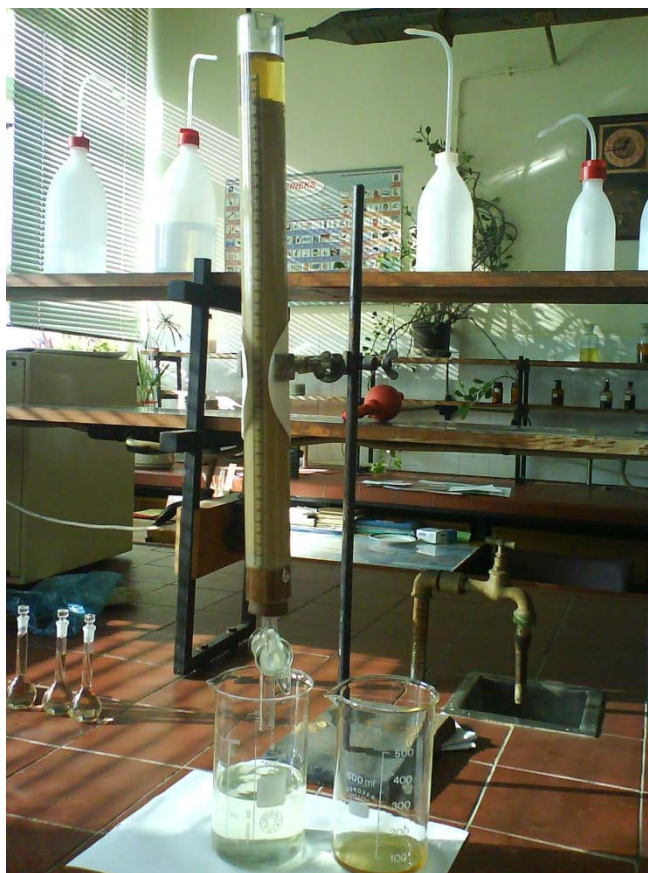
Slika 5.2 Adsorpciona kolona: prečnik kolone 32 mm; visina kolone 500 mm; visina sloja trine u koloni 400 mm; protok vodene faze 10 \text{ ml min}^{-1}
