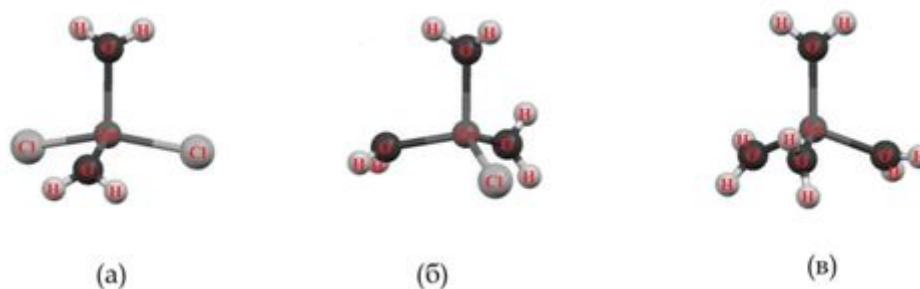
Слика 4.17 Модел системи коришћени за прорачуне за тетраедарске комплексе цинка са различитим наелектрисањем; (а) неутрални комплекс [\text{ZnCl}_2(\text{H}_2\text{O})_2] , (б) комплекс [\text{ZnCl}(\text{H}_2\text{O})_3]^+ , (в) комплекс [\text{Zn}(\text{H}_2\text{O})_4]^{2+} .
