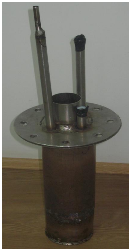
Slika 5.8. Fotografski prikaz elektri ne pe i i reaktorske posude
