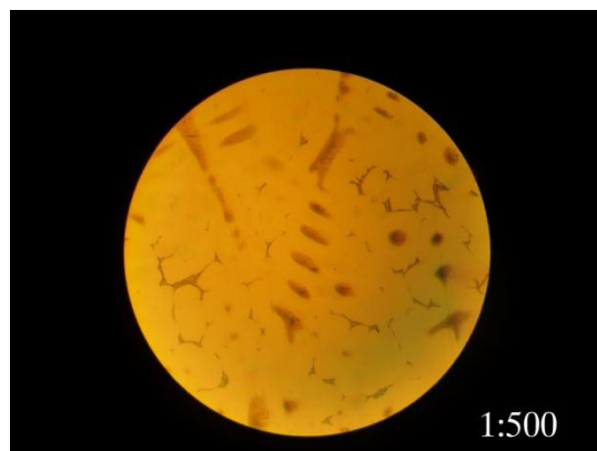
Slika 71. Legura G3 (Cu 60 Al 20 Au 20 )
