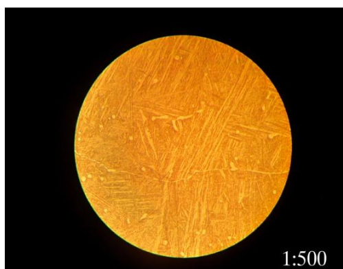
Slika 23. Legura C4 ( Cu_{70}Al_{24}Ag_6 )
