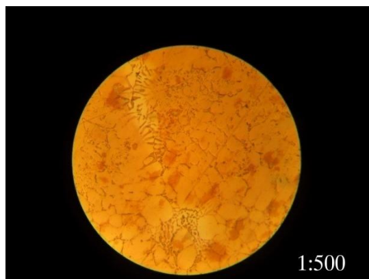
Slika 77. Legura J1 ( Cu_{40}Al_{40}Au_{20} )
