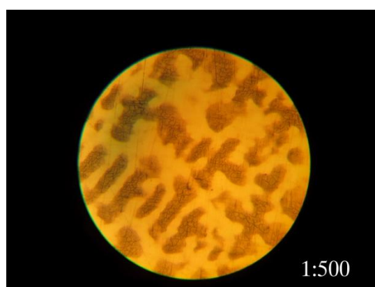
Slika 72. Legura G4 (Cu 80 Al 10 Au 10 )
